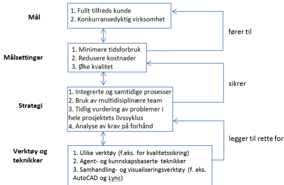
Figur 6: Rammeverk for å implementere CE (basert på Kamara et al. (2000))
