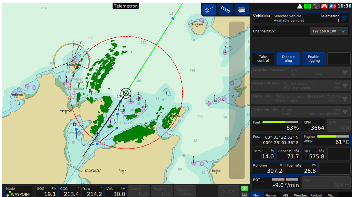
Figur 30: Maritime Robotics' system for overvåking av fartøy fra operatørstasjonen. (Hepsø, 2016)
