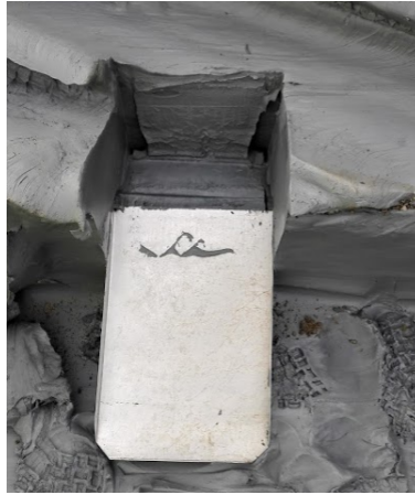
Figur 5.2: Stålplate brukt for henting av blokkprøver
