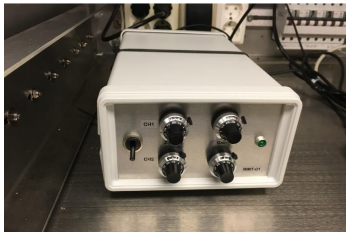
Figur 19 Analog boks som kalibrer bølgesensor
