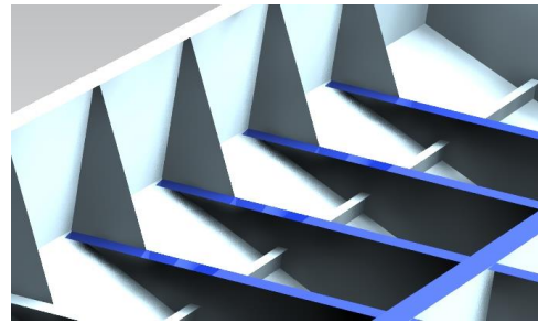
Figur 5.7 Illustrasjon knekket flens
