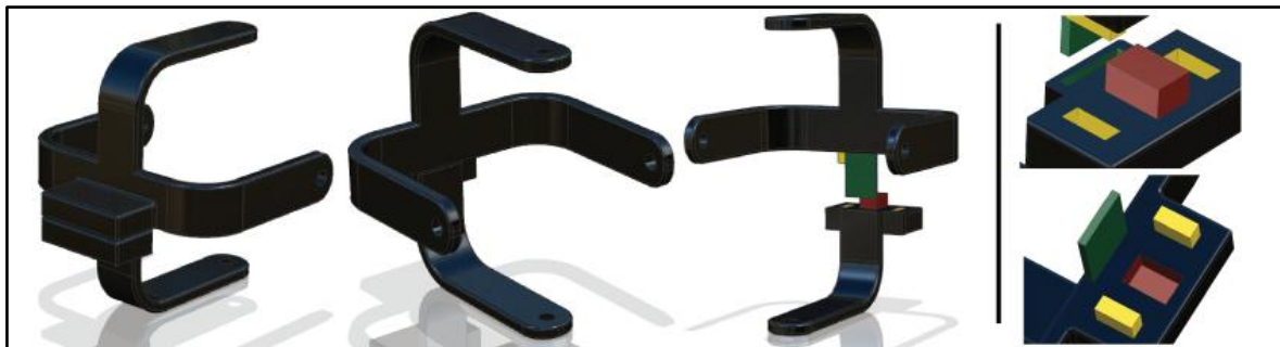
Figur 4.7: Bur med bakplate montering
