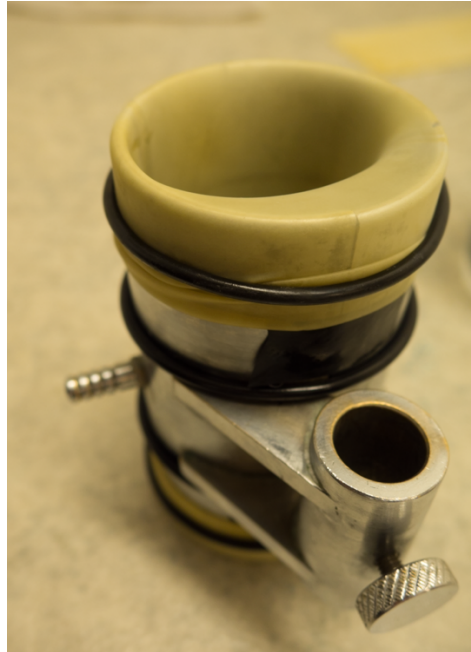
Figur 5. Monteringsrør brukt til å bygge prøven inn i membran
