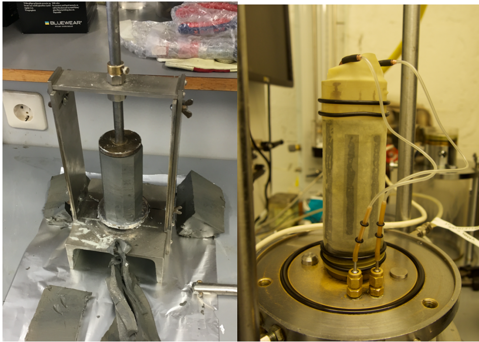
Figur 6. Trimming av sylinder til treaksialforsøk (t.v.). Ferdig montert prøve i apparat (t.h.)
