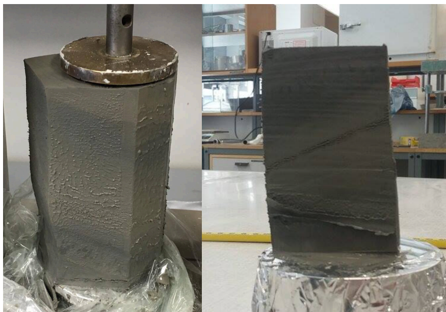
Figur 28. Bilder av treaksialprøve 3A (t.v.) trimming av prøven før forsøk (t.h.) delt prøve etter forsøk
