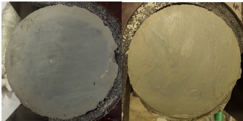
Figur 24. Bilde av avkappet topplokk. Blokk 1(20°C) t.v. Blokk 2(5°C) t.h.
