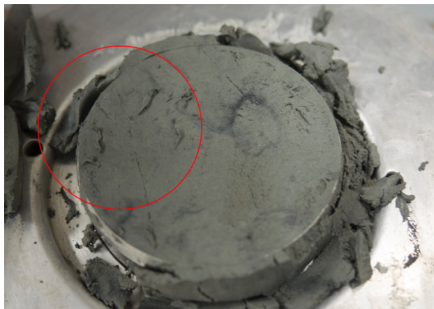
Figur 33. Ødometerprøve med riss/sprekker
