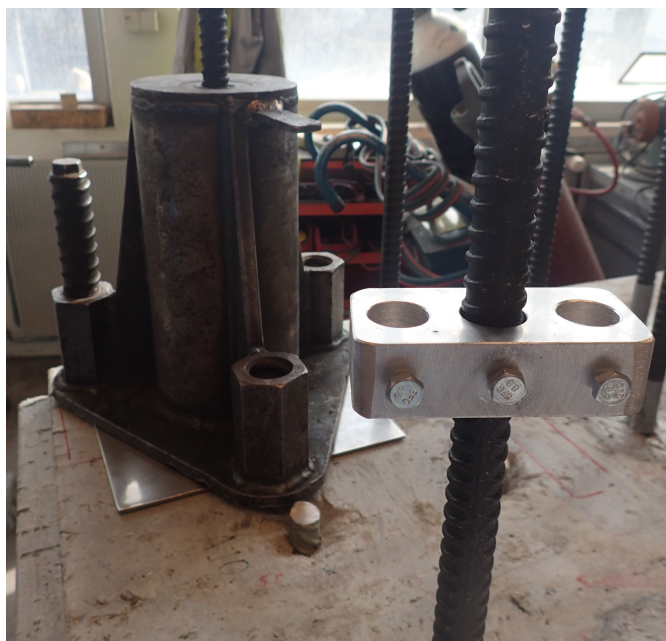
Figur 4.7: Aluminiumsprofilen som fester LVDT-ene til staget. Pedestallen oppå kun stålplaten i bakgrunnen. Foto: Undertegnede.
