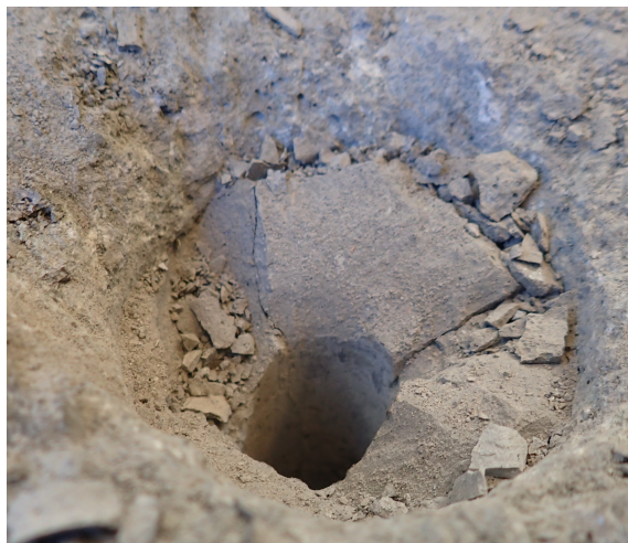
Figur 5.6: Borhullet til stag ST150-1 etter at mørtelkonus og stag er fjernet.
