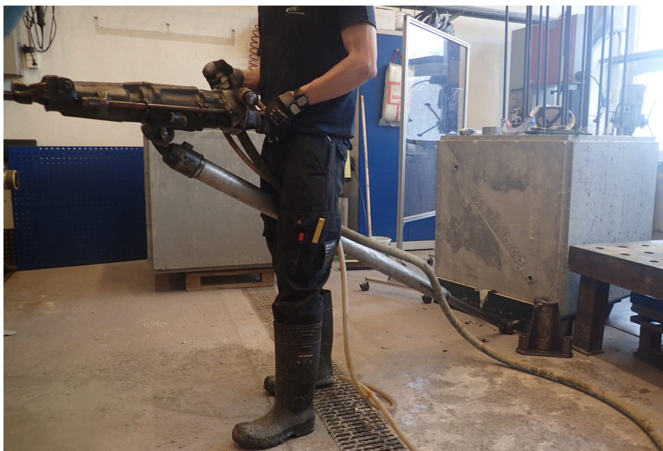
Figur 4.2: Bilde av borhammeren som støttes av et trykkluftben mot en annen betongblokk. Foto: Undertegnede.
