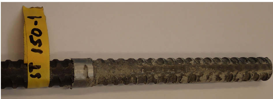
Figur 5.2: Stag ST150-1 etter utrivning. Bruddet gikk som ønsket.
