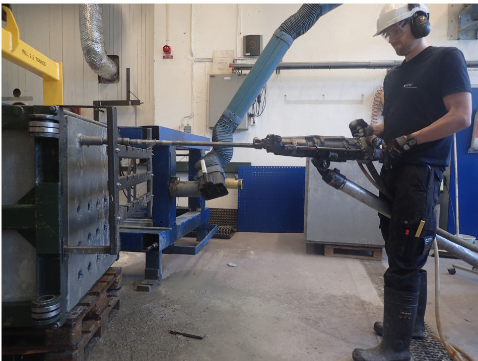
Figur 4.3: Bilde av borhammeren og stativet under boring. Foto: Undertegnede.
