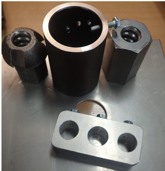
Figur 9.11: Mutterstrammeren med Z-skruer, muttere og LVDT-holder.
