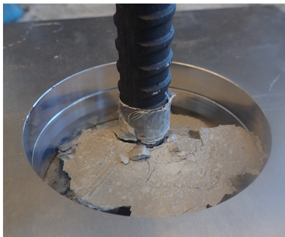
Figur 5.5: Stor mørtelkonus etter brudd, stag ST150-1.
