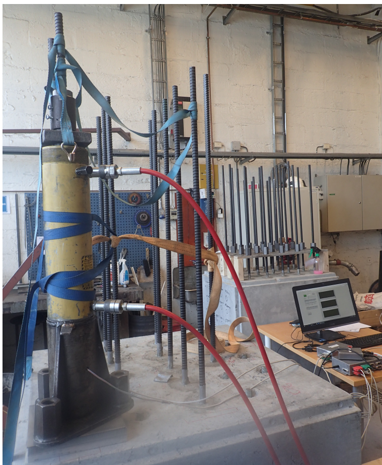
Figur 4.9: Fastsurring av stag og hydraulikksylinder under testing.
