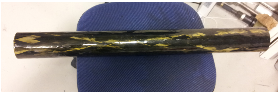
Figur 6.17: Karbonfiberbelagt rør spunnet ved IPM
