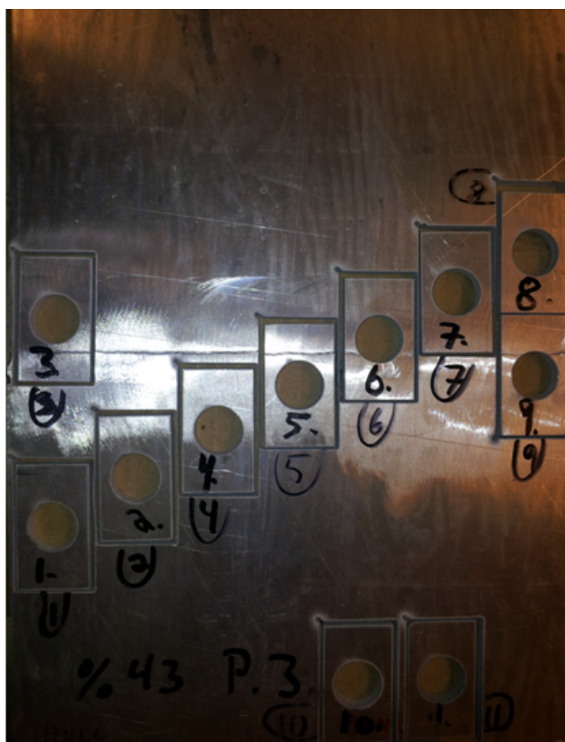
Figur 4.6: Vannskjærte hulltrykksprøver og dimensjoner på hulltrykksprøver
