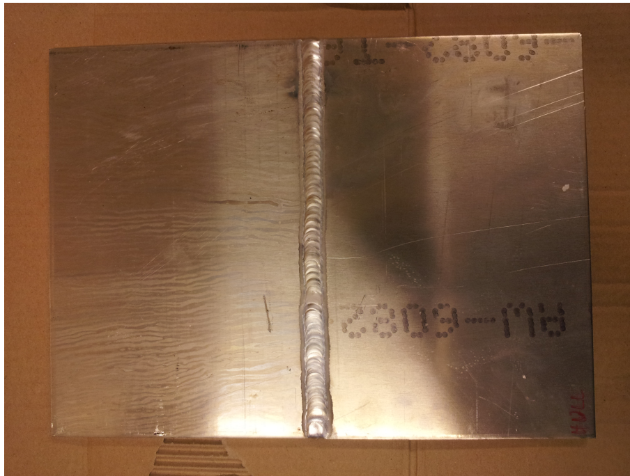
Figur 4.4: Sveist 5 mm aluminiumsplate i legeringen AA6082-T6
