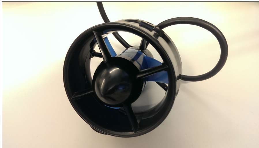
Figur 4.1: Original T200 thruster med medfølgende tunnel m/ feste.
