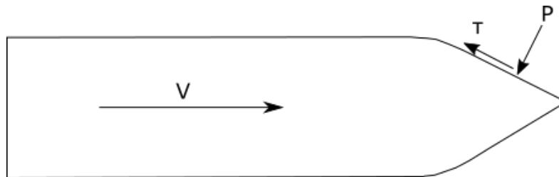
Figur 2.7: Krefter som virker på et skip i bevegelse
