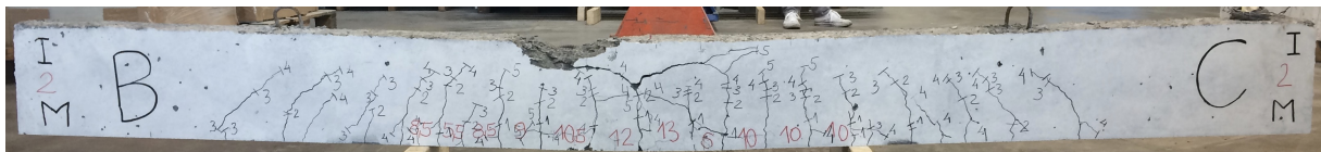
Figur 6.11: Riss etter brudd i momentbjelke side 2, 182.8\text{ kN}
