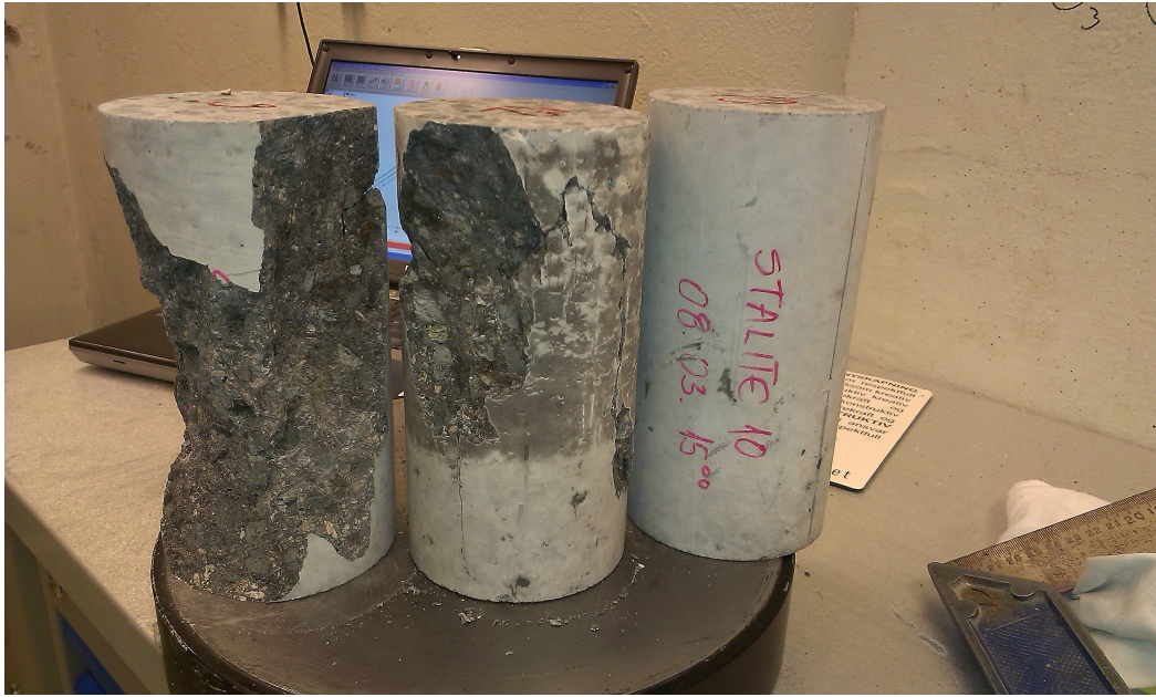
Figur A.6: Trykktest av sylindere i ToniTechnik maskin
