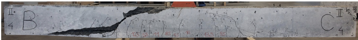
Figur 6.5: Riss etter brudd i a/d = 4.0(II) , 124kN
