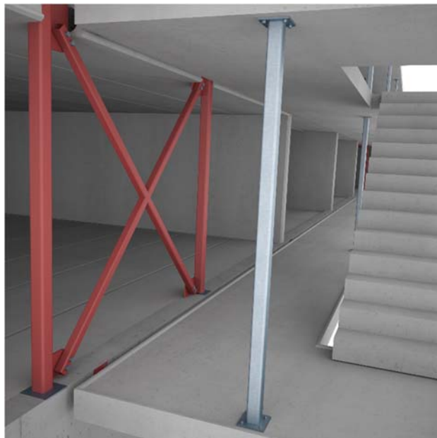
Figur 24 - Stålkryss fra Revit-modellen.
