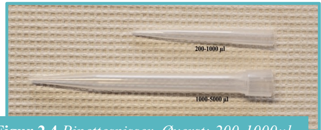
Figur 2.4 Pipettespisser. Øverst: 200-1000µl. Nederst: 1000-5000µl.
