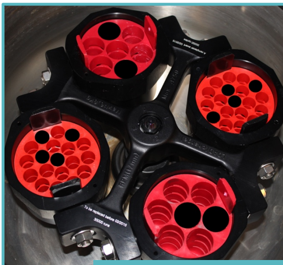
Figur 3.4 Feil balansering av sentrifuge, Juan CR4i
