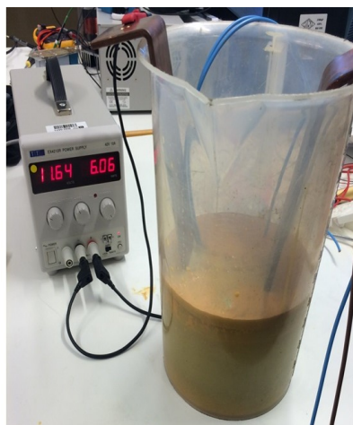
Figur 6.3: Fremprovosere oksidbelegg på ledere og koblingspunkter ved å benytte elektrolyse prosess
