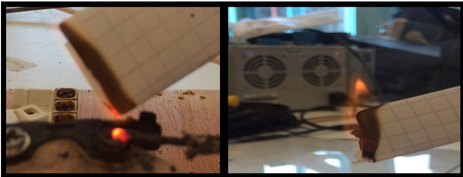
Figur 6.21: Antennelse av papir. Papiret ble ført mot den glødende forbindelsen. Det oppsto flamme etter få sekunder
