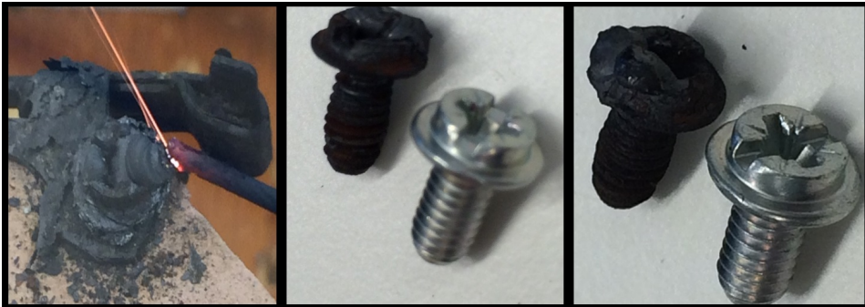
Figur 6.19: Oksidbelegg som blir dannet i kontaktforbindelsen. Bilde til venstre viser gnisninger
