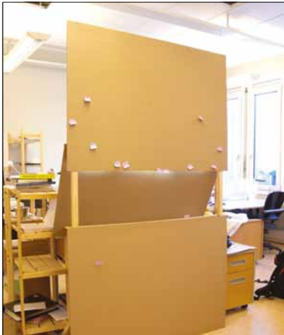
En kjapp prototype for å teste hvordan en vegg med innfelt vask ser ut og føles å bruke. Første kommentar var: "En typisk guttevask".
