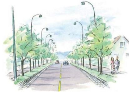
2.11 Visuelle fartsdempende tiltak
