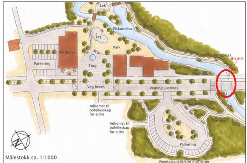
Figur 1.1.3: En skisse som viser fremtidige planer i Fiskum: grønn parkeringsplass, ny butikk, stiene langs elva, hvileplass, veg heves, veglinje justeres[1].
