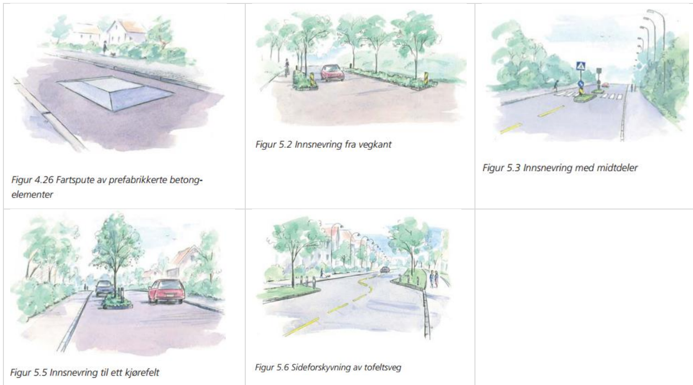
Figur 10.6.1: Bilder for fartsdempende tiltak fra Håndbok V128[31].
