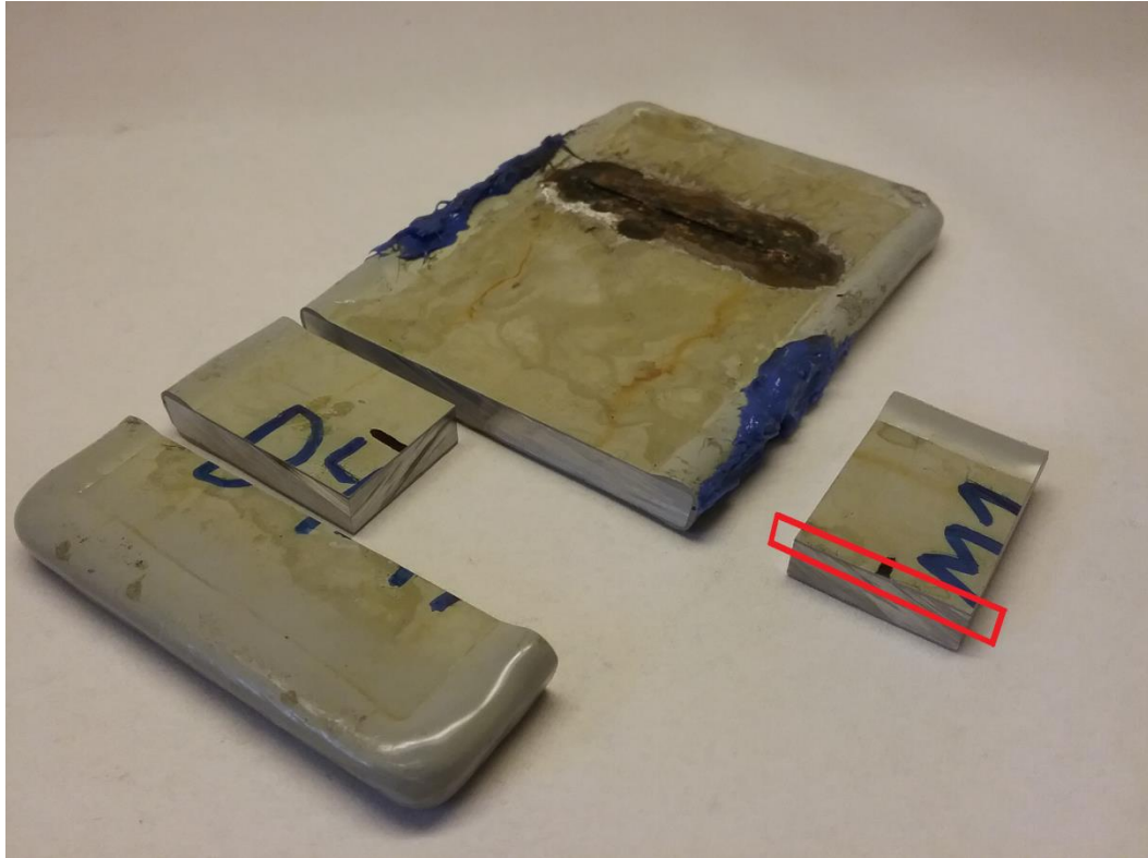
Figur 22: Bildene viser hvor tversnittbitene ble skjært ut fra prøvene. Den røde firkanten illustrerer området som ble observert i lysmikroskop.
