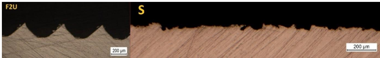
Figur 12: Figuren sammenlikner maskinert flate opp mot blåserenset flate. Den blåserensede flaten hadde betraktelig høyere belegglevetid, på tross av den lave ruheten. Legg merke til forskjellen i målestokk på de to figurene. Bildene er hentet fra Hognestad [60]
