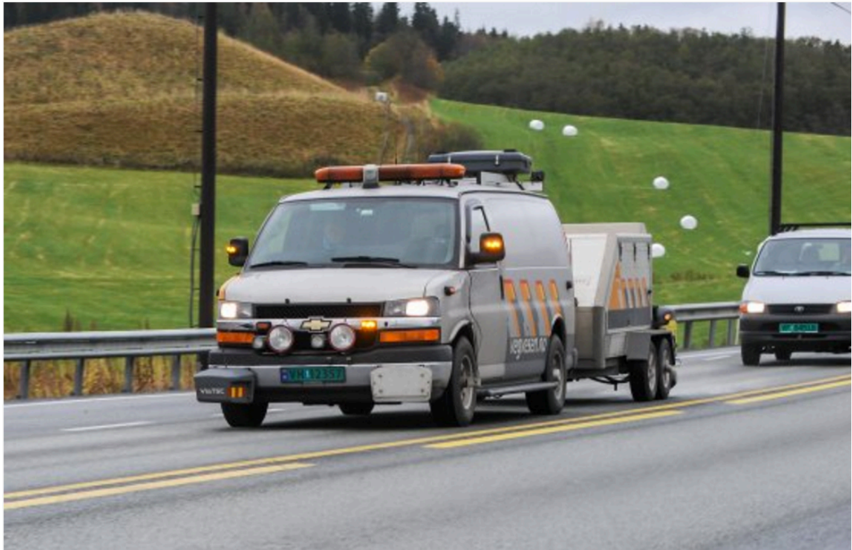
Figur 1 Tilstandsregistreringsbil ute på oppdrag (Foto: Knut Opeide. Gjengitt med tillatelse fra SVV)
