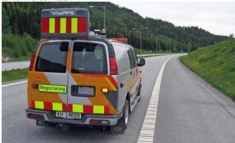
Bilde 4: Målebil for spor, ujevnheter og tverrfall. Foto: Torleif Haugødegård (SVV)
