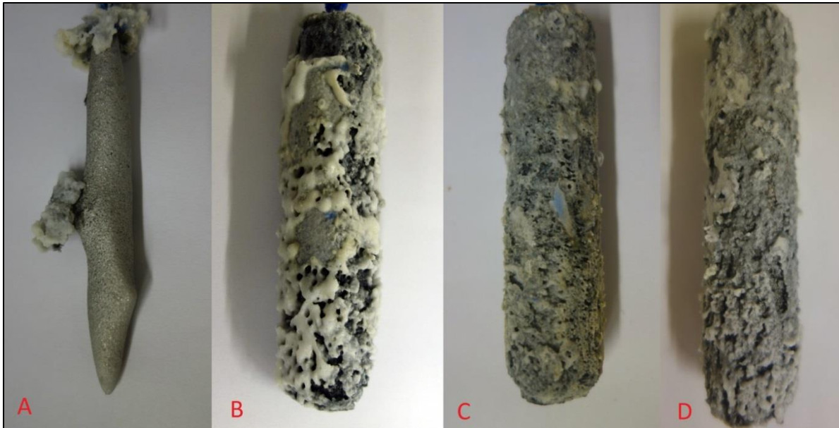
Figur 33- Prøvestykkene A-D etter forsøket, med oksidlaget intakt.
