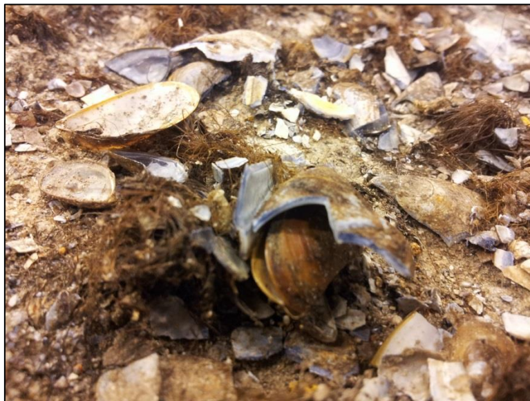
Figur 17 - Overflaten til offeranoden fra Ekofisk
