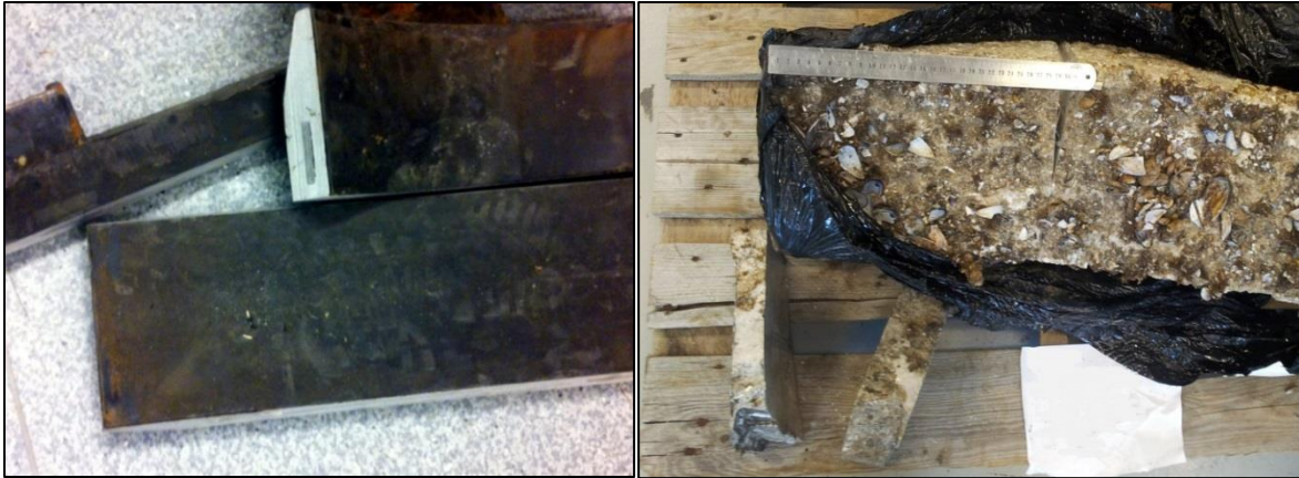
Figur 16 – T.v. braceletanode. T.h. stand-of-anode fra ConocoPhillips
