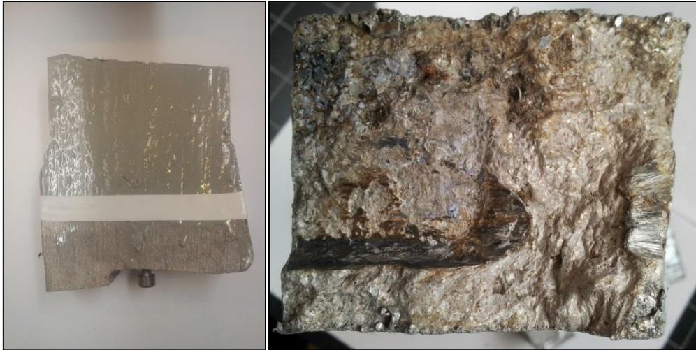
Figur 18 – Malt og isolert prøve og endeflaten til prøve E
