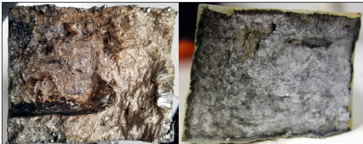
Figur 37- Prøve E før og etter forsøket indikerer en utjevning av overflaten, men lite oksiddannelse.
