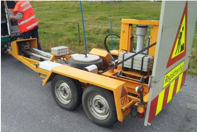
Figur 2: Vegvesenets fallodd, av typen Dynatest ved Fv 24 nord for Skarnes
