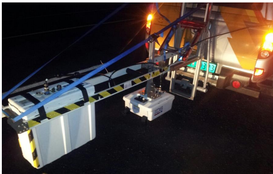
Figur 19: Georadar ferdig rigget på bil ved Stange. Hornantennen sees som den store boksen lengst til venstre og den mindre boksen i midten er «ground coupled» antenne med to kanaler på 400 og 900 Mhz
