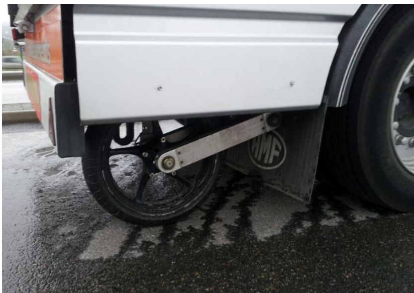
Figur 8: Bildet viser metreringshjulet som er påmontert bak hengerens aksel. Dette kan heises opp og ned fra førerhuset.
