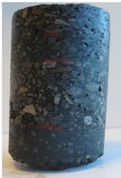
Figur 17: Bilde av en typisk borkjerneprøve, med markering for tydelige lagskiller (Foto: Viktor Hedfors, Jan Fredrik Hertenberg)
