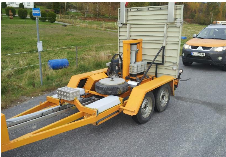
Figur 16: Falloddet, med følgebil på plass ved Fv 24 nord for Skarnes
