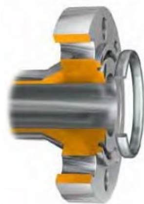
Figur 2-2: Skjematisk tegning av Ring Joint pakning (OLF, 2011).
