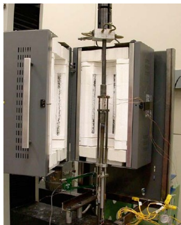
Figur 3-5: Strekktestmaskin med elektrisk varmeovn (Blandford, Morton, Snow, & Rahl, 2007).
