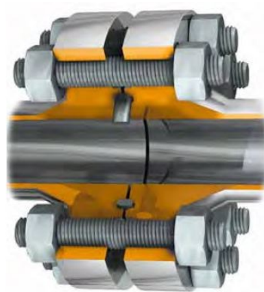
Figur 2-1: Skjematisk tegning av Ring Joint flensforbindelse med flenshalvdeler, metallpakning og bolter (OLF, 2011).
