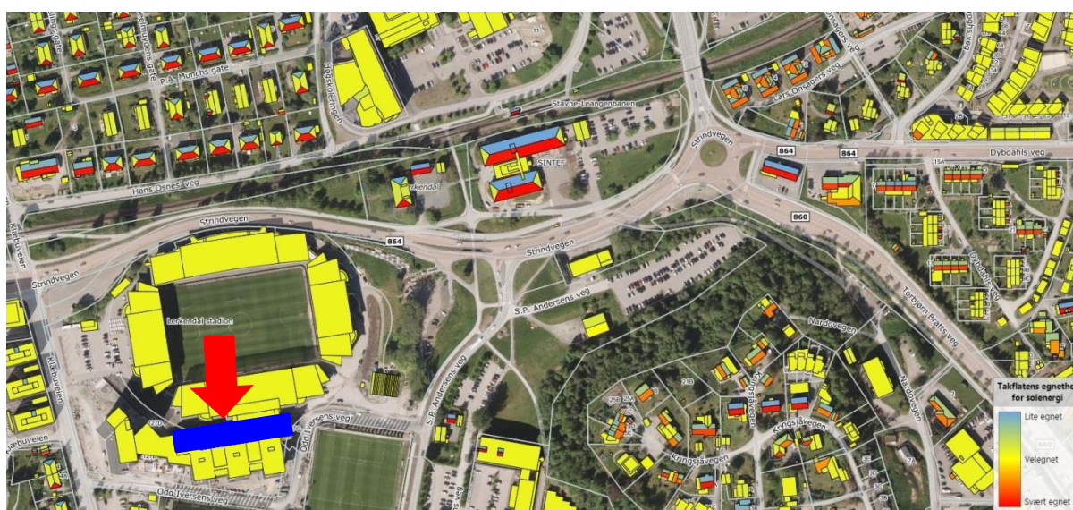
Figur 13 Solpotensialet på takflater for Lerkendalsområdet i Trondheim. Solfangere på Scandic Lerkendal markert med blå firkant og rød pil (solkart.no, 2016).
