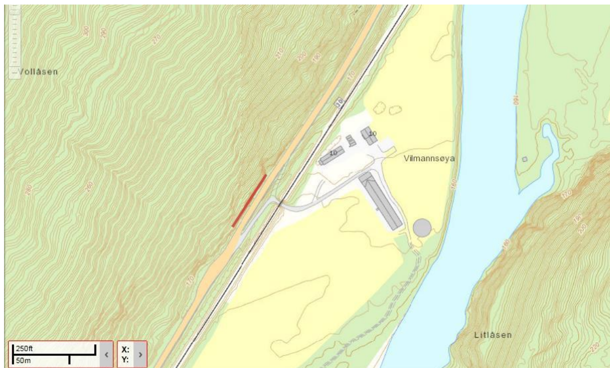
Figur V- 56) Detaljkart for punkt Villmannsøya, 3 km vest for Singsås. Iskjøvingen oppstår i en lav skjæring og grøft på venstre side av vegen, markert med rød linje (Jernbaneverket, 2016).
