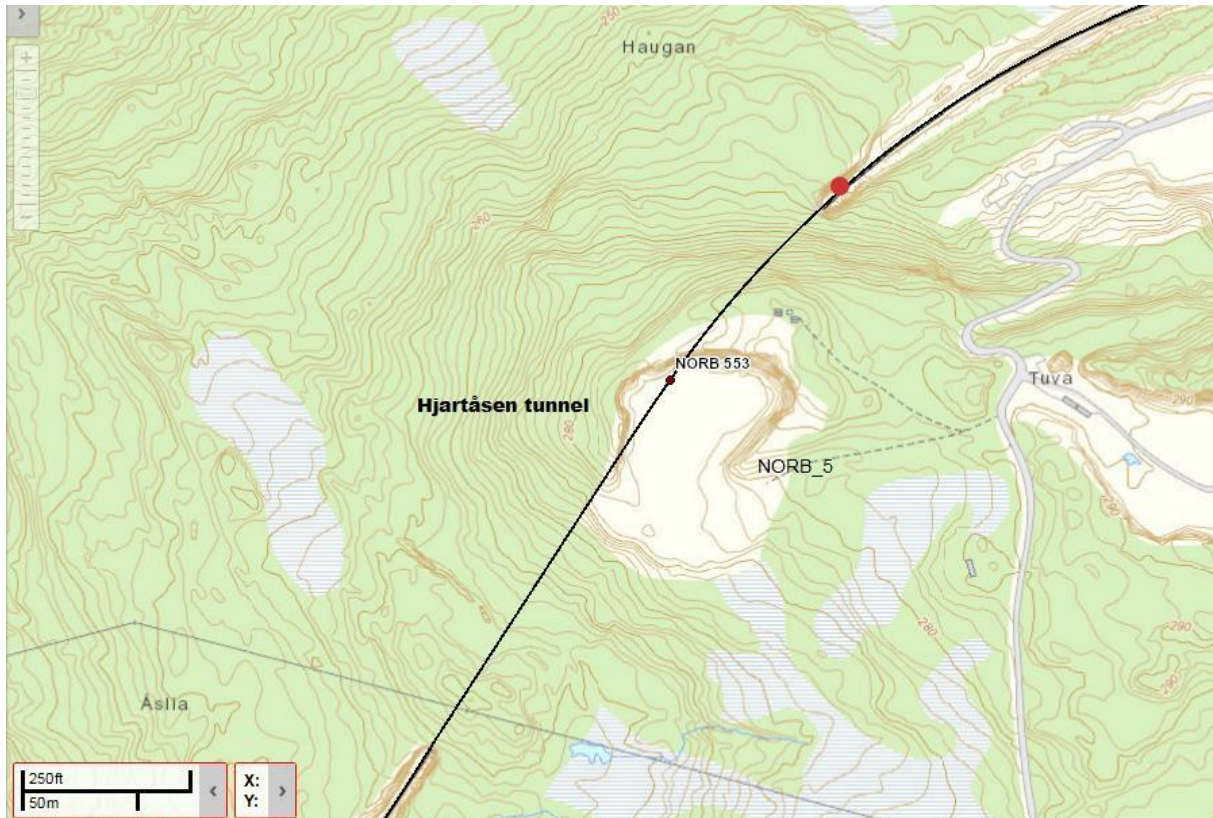
Figur V- 88) Hjartåsen tunnel. Rødt punkt viser plasseringen av isnisje utenfor den nordre tunnelportalen (Jernbaneverket, 2016).
