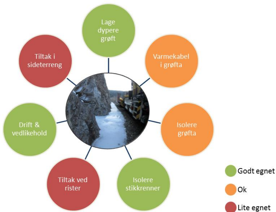
Figur 103) Anbefalte strategier for å forebygge iskjøving i grøfter som følge av is i stikkrenner.
