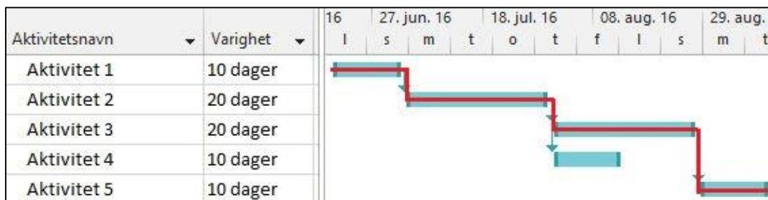
Figur 7: Koblede aktiviteter som utgjør kritisk linje. Kritisk linje er illustrert med rødt.
