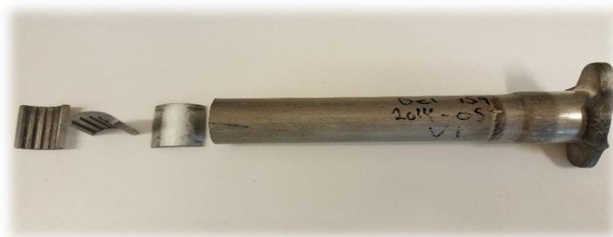
Figur 3.1.2.3: Viser bilkomponenten i sin helhet etter kaldforming med fortanning og trekkbrotsjing etter varmebehandling.
