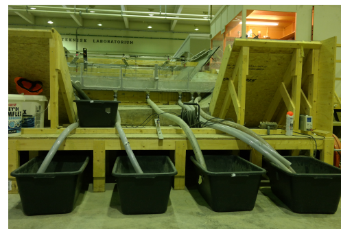
(b) Beholdere til oppsamling av vann
