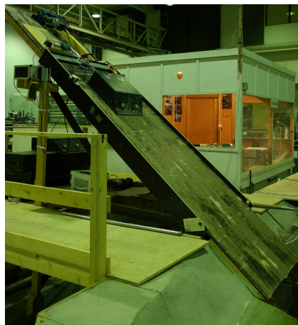
Figur 12: Skredrampe med én skredblokk
