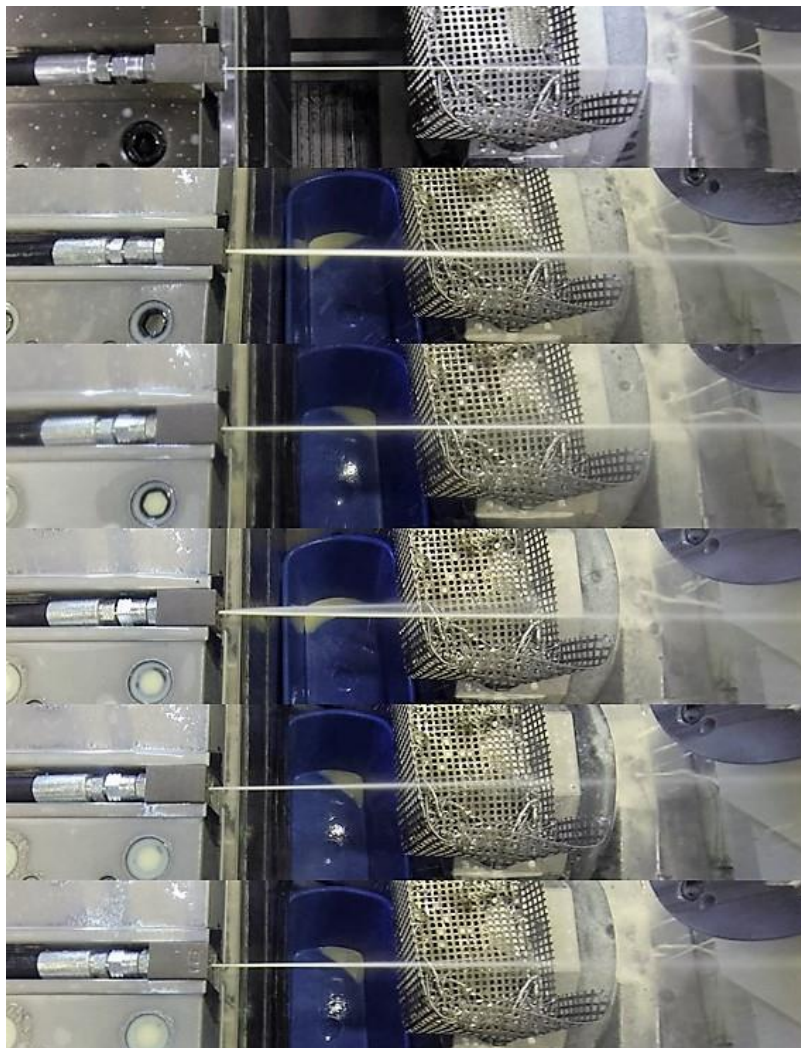
Figur 3.9, Fotografering av væskestråle ved 10 bar. Dyse 1-6 fra toppen.
