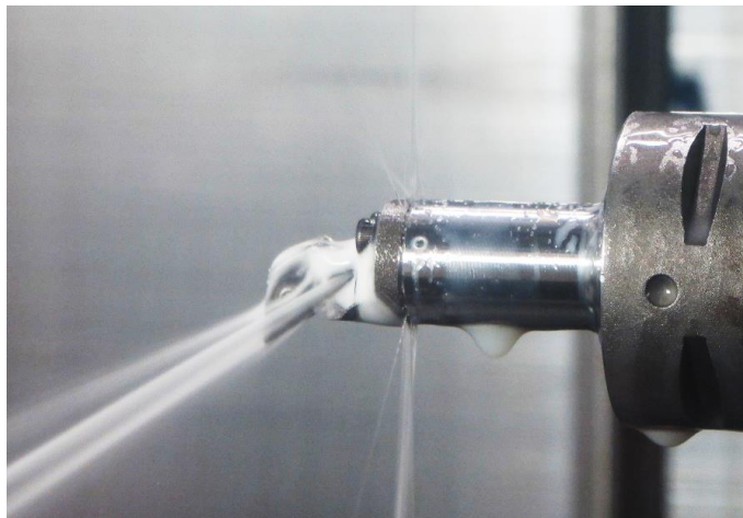
Figur 5.4, Testing av spylekanal hode 1 ved 40 bar.
