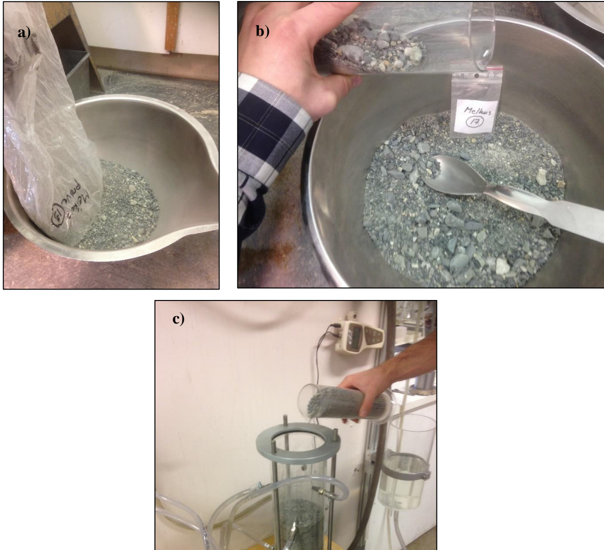
Figur 17: Preparering av prøvematerialet for permeameteresting. a) Prøvematerialet blir helt ned fra prøvetakingsposene og ned i en metallskål. b) Prøvematerialet blir spadd inn i en glassylinder. c) Prøvematerialet helles ned i permeameteret fra glassylinderen i et sirkulært bevegelsesmønster.
