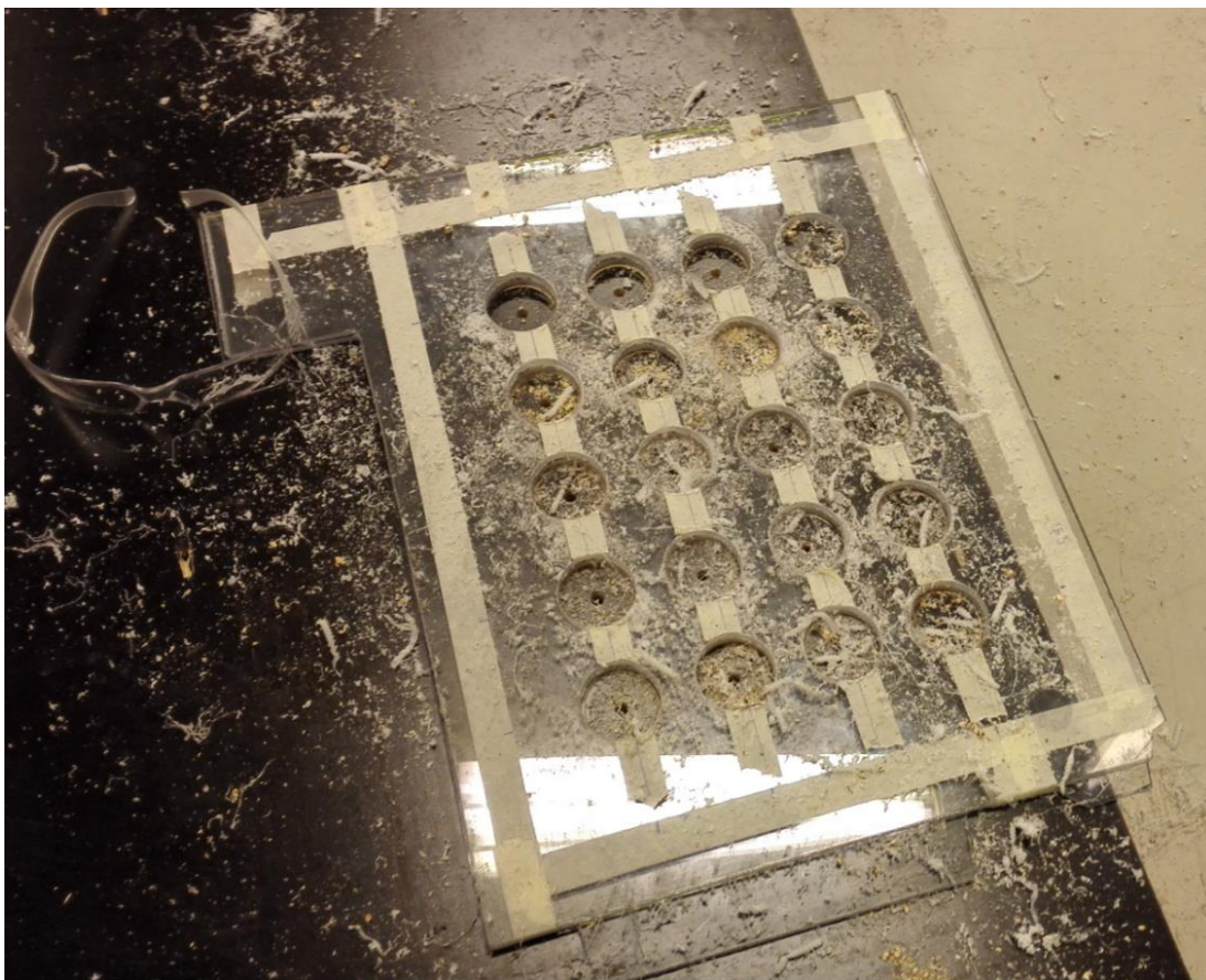
Bilde 5: Boring av tørkebrett
