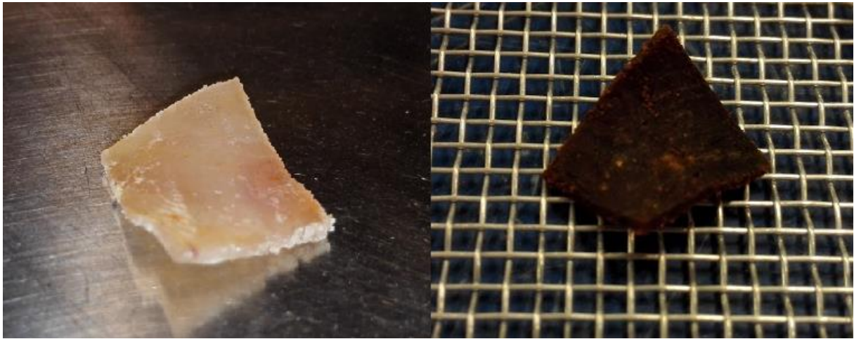
Bilde 23: Fargeforskjell før og etter konveksjonstørkeren (100 °C)
