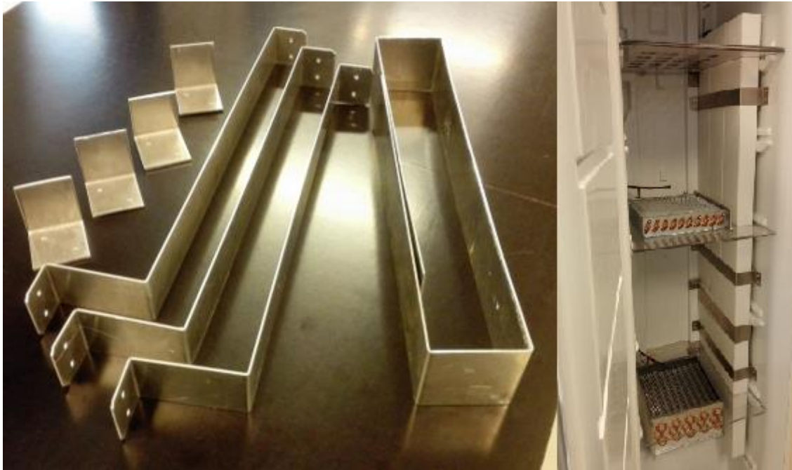
Bilde 3: Tilvirkede vinkler (venstre) og montert kanaler (høyre)
