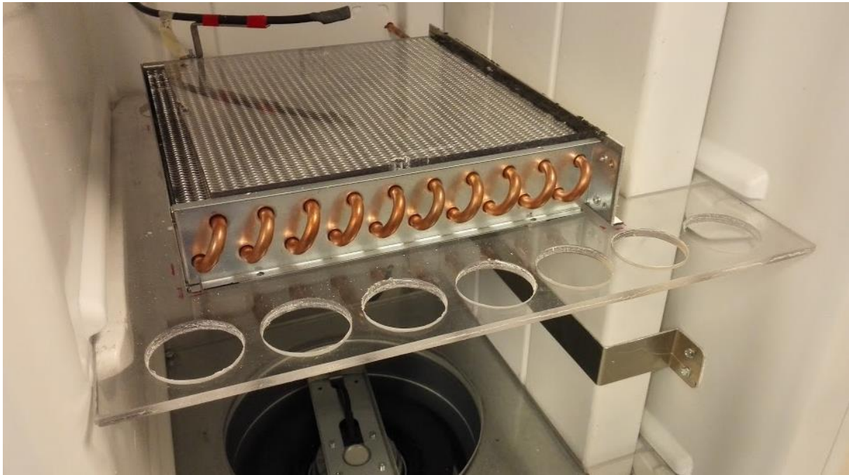
Bilde 20: Blindplate over kondensator
