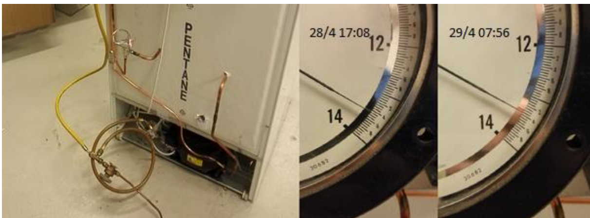
Bilde 17: Tilkobling av nitrogenflaske (venstre), trykkavlesninger (høyre)
