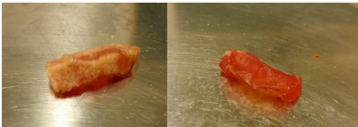
Bilde 24: Skorpedannelse (venstre), prøve uten skorpedannelse for sammenligning (høyre)
