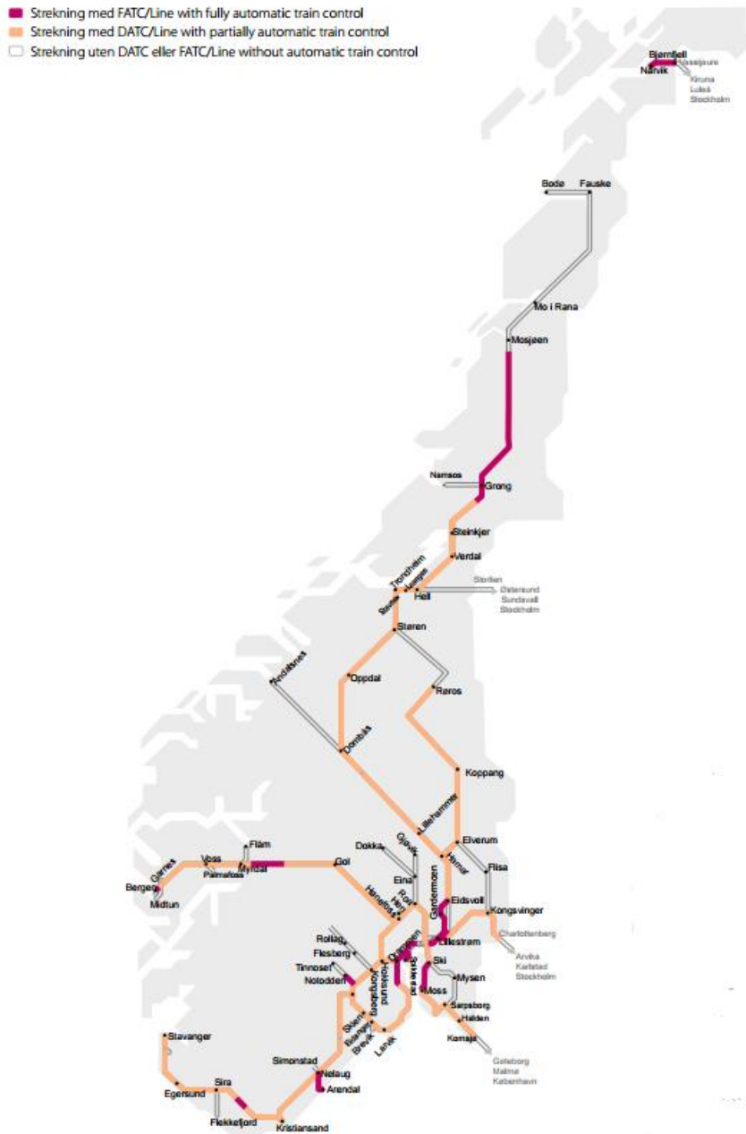
Figur 4: Strekninger med fullt (FATC —) og delvis (DATC —) utbygd ATC (Jernbaneverket, 2014)
