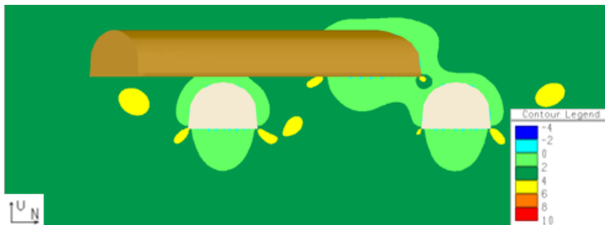
Figur 111 Snitt V3: Konturene av sigma 3 i MPa. Middelerdier fra tabell 24 og tabell 27. Spenninger fra målinger på Mongstad fra tabell 23.
