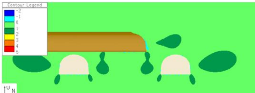
Figur 154 Snitt V4: Konturene av sigma 3 i MPa. Maksimumsverdier for UCS og E-modul fra tabell 27.
