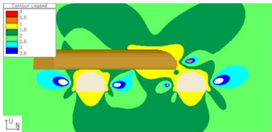
Figur 143 Snitt V3: Konturene av styrkefaktor. Minimumsverdier for Hoek-Brown konstanter fra tabell 24
