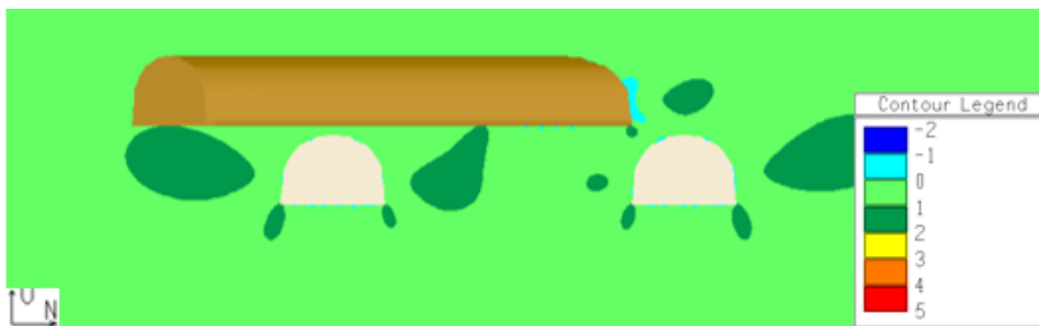
Figur 97 Snitt V3: Konturene av sigma 3 i MPa. Middelveier fra tabell 24 og tabell 27 og spenninger fra tabell 21
