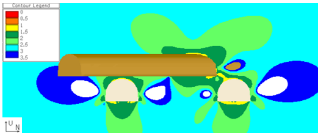
Figur 157 Snitt V3: Konturene av styrkefaktor. Maksimumsverdier for UCS og E-modul fra tabell 27.
