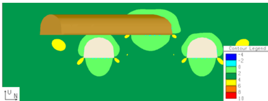
Figur 112 Snitt V4: Konturene av sigma 3 i MPa. Middelerdier fra tabell 24 og tabell 27. Spenninger fra målinger på Mongstad fra tabell 23.
