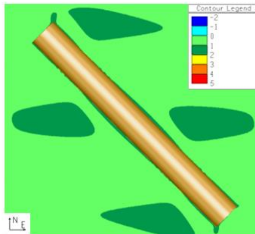
Figur 127 Snitt H1: Konturene av \sigma_3 i MPa. Maksimumsverdier for Hoek-Brown konstanter fra tabell 24
