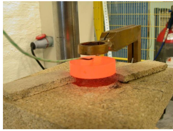
Figur 59 – Oppvarming av kobbersylinder uten noe isolasjon rundt.
