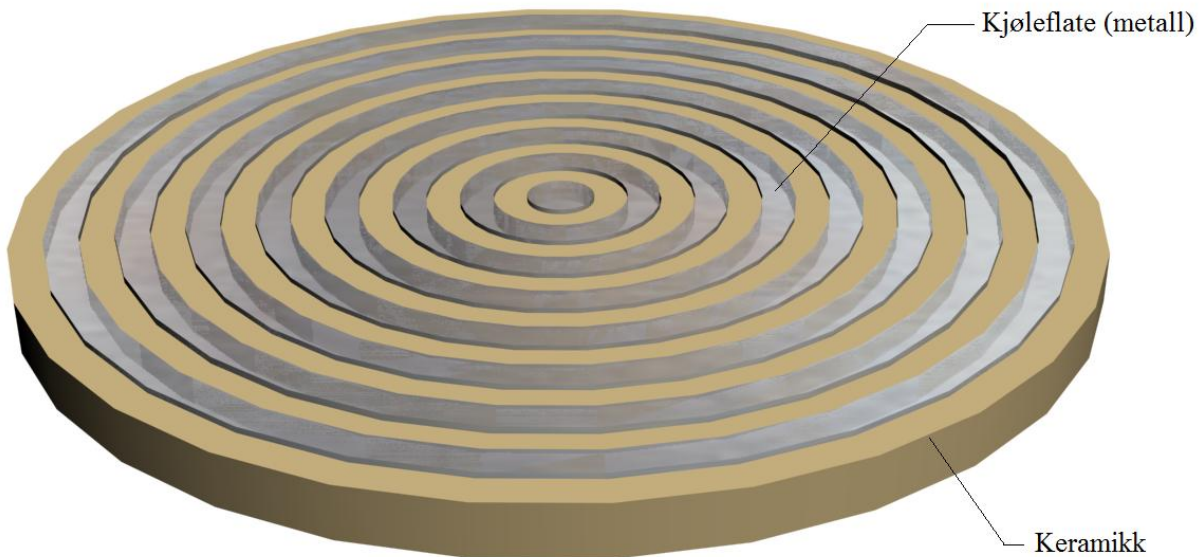
Figur 18 - Kjøleflate; metallringer med keramikk på utsiden og mellom ringene.
