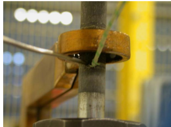
Figur 62 – Responstest mantlet termoelement på en stålsylinder.
