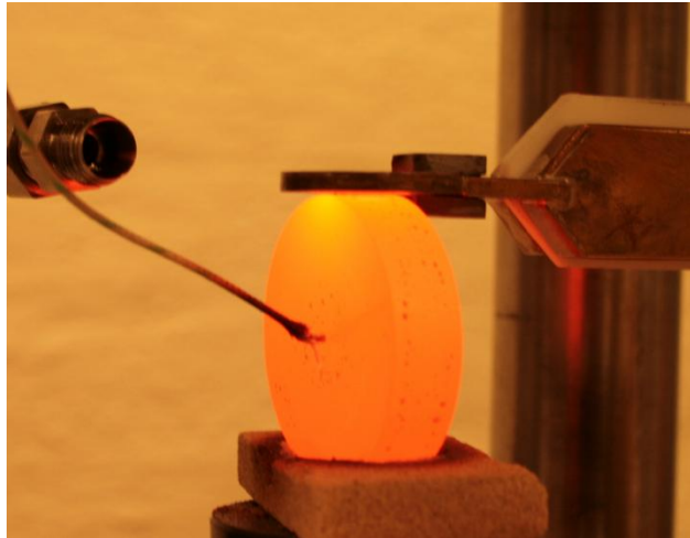
Figur 16 - Testforsøk 02.03.2010; oppvarming av kobbersylinder ved spolen.
