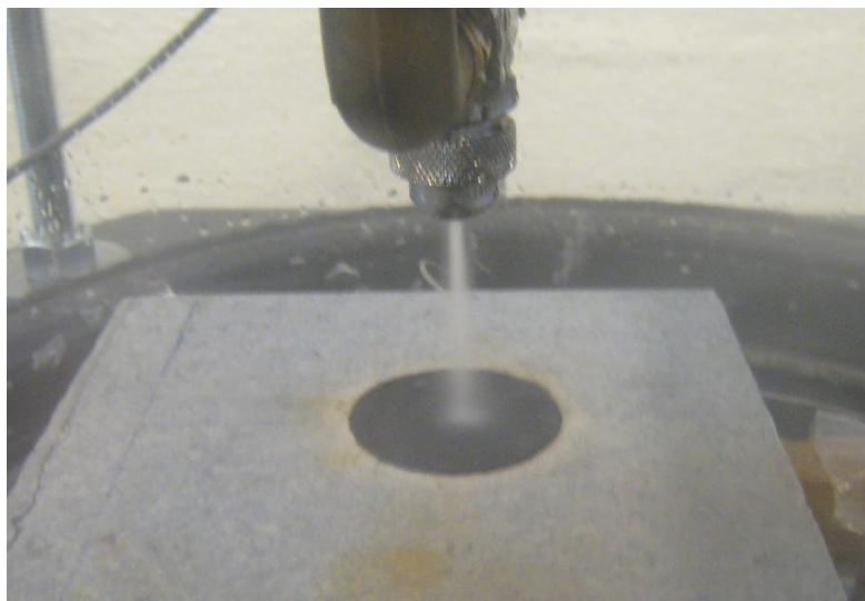
Figur 93 - Tofasedyse med vann og nitrogengass. Sprayen treffer en liten del av kobbersylindren.
