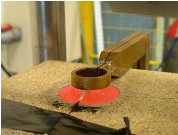
Figur 58 – Oppvarming av kobbersylinder liggende i en kopp av isolasjon.
