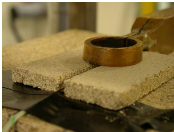
Figur 57 – Oppvarming av kobbersylinder dekket i isolasjon.
