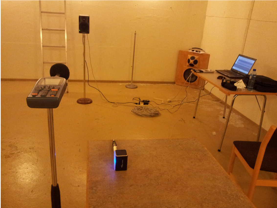
Figur 4.7: Bilde av måleoppsettet i lydrom 3 for STIPA-måling med den lille høyttaleren i stående posisjon, 25 cm i horisontal avstand fra måleinstrumentet.
