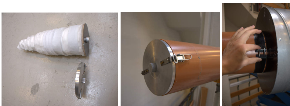
Figur 3.15: T.v: Bilde av endestykkene. Midten: Endestykke montert med hengsler. T.h: Festemetoden.
