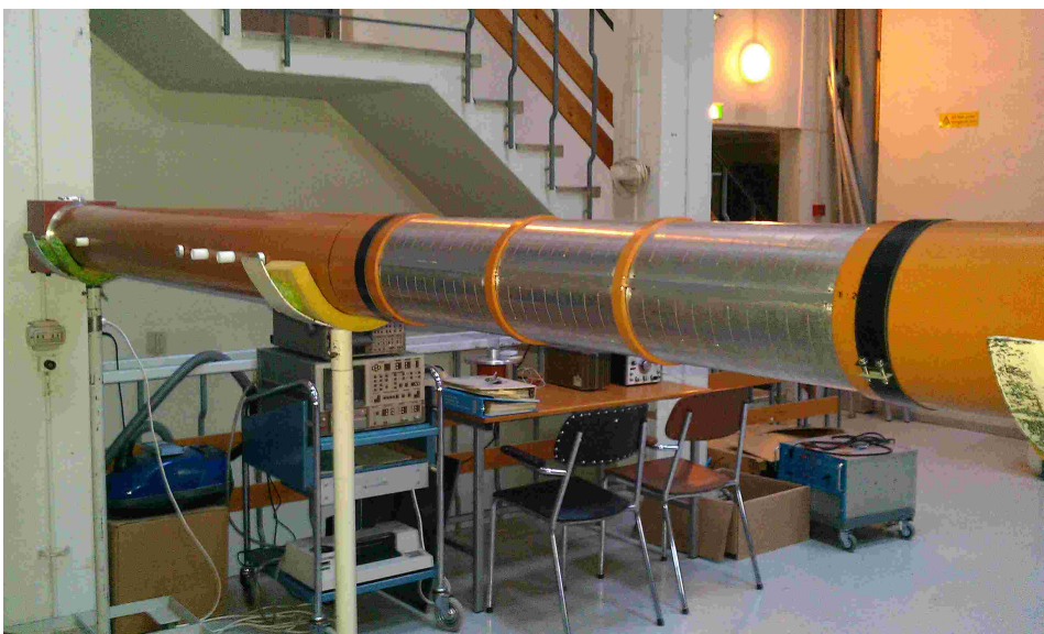
Figur 3.11: Åpen plate C i målekanal. De tynne båndene rundt platen brukt for å holde platen sammen etter liming, og ble fjernet under målingene.
