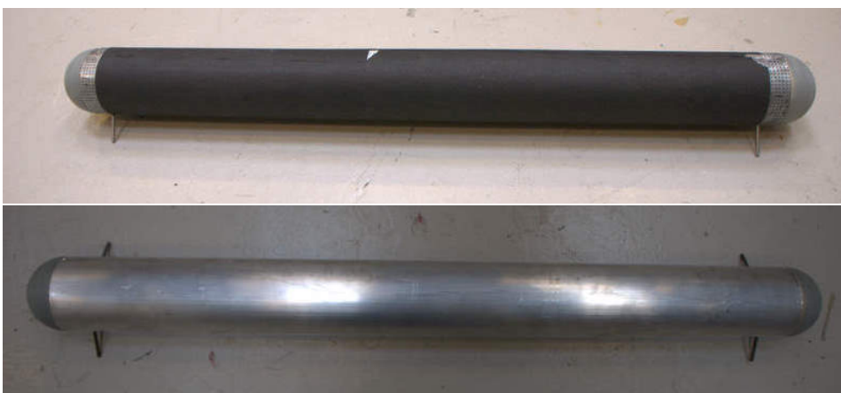
Figur 3.12: Øverst: Perforert pod med Soundtex-duk utenpå. Nederst: Hard pod.
