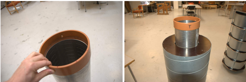
Figur 3.9: En kloakkrørbit trykkes innpå enden av mikrospalterøret, ved hjelp av et utskjært spor. Deretter føres platen inn gjennom ytterskallet til demperen. Til slutt festes en tilsvarende kloakkrørbit i andre enden av platen.
