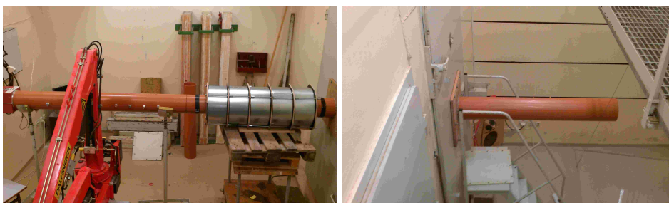
Figur 3.19: T.h. Bilde av senderrommet med demper 1 montert i kanalen. T.v. kanalen som munnar ut i mottagerrom.
