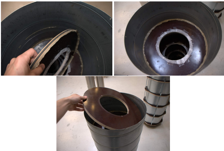
Figur 3.8: Innvendige vegger har en list i kanten, så veggene kan trykkes fast inne i røret. Innvendige vegger ble tettet i midten med stoff, og langs det ytre røret med plastillin. Ytterveggen som er løs bankes på plass.
