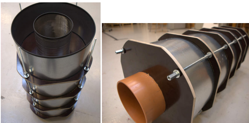
Figur 3.5: T.v. kan en se hvordan hvert kammer ser ut, før demperen er ferdig montert. T.h. ser en tydelig skruene som holder på plass kammerene.
