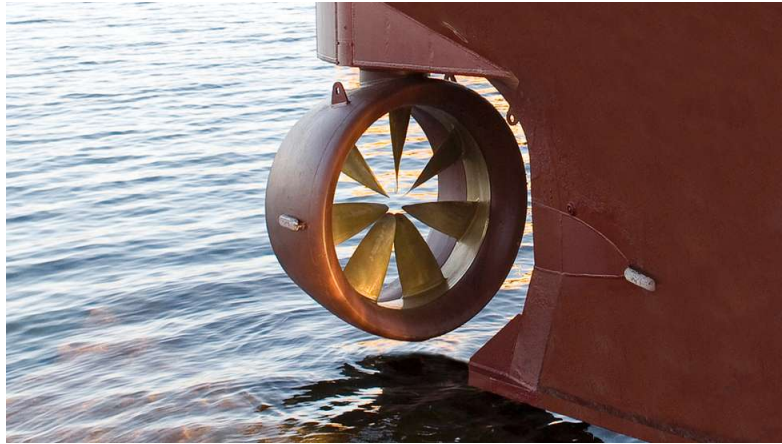
Figur 2.3: Asimut RDT for fremdrift på MF «Eiksund». Bildet er hentet fra [14].
