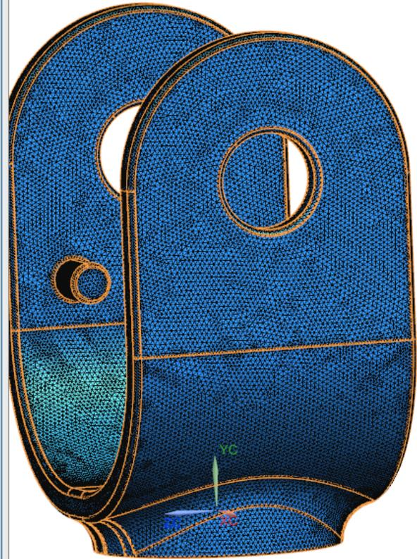
FIGURE 146: UMBILICAL FIXTURE MESH - 0,5MM CTETRA(10) ELEMENTS
