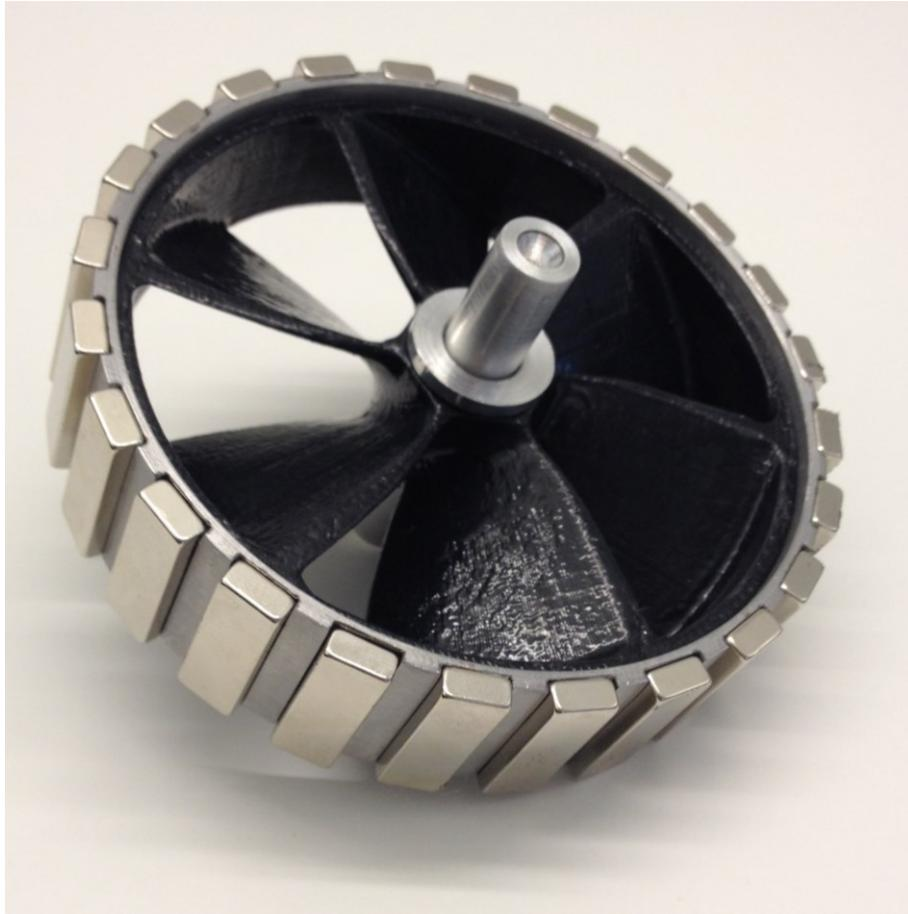
**FIGURE 89: FINISHED PROTOTYPE ROTOR**
