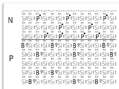
Figur 8 Elektron-hull-par. Løse elektroner markert i svart, og hull markert med ring.
