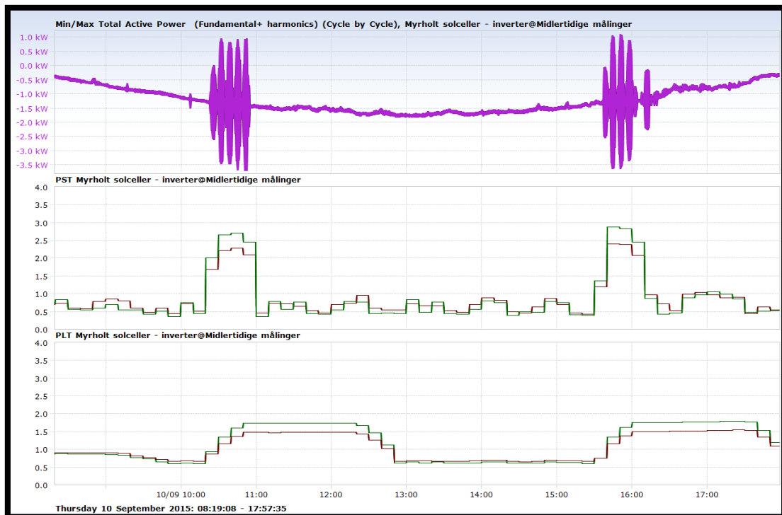
Figur 55 Eksempel på flimrer samtidig som resonans. L1 og L2 får P_{st} opp rundt 2,3 -2,7, og P_{lt} stiger gradvis mot 1,5-2. Utenom periodene med resonans, ligger flimmerverdiene innenfor kravene til FoL. Dette er et eksempel på at resonansfenomenet i mellom inverter og øvrig nett skaper flimrer over kravene satt i FoL.
