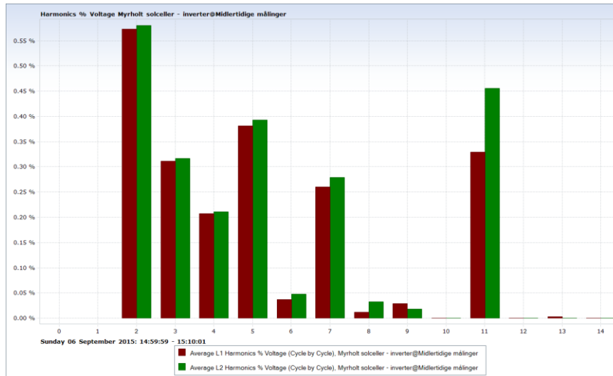
Figur 58 Oversikt over de 14 første overharmoniske spenningene på Myrholt. Dette er snittverdier fra en 10-minutters periode på dagtid hvor det er innslag av resonans.
