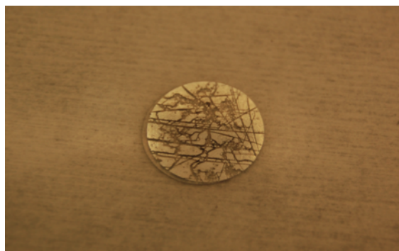
Figur 4.1: Bildet viser hvordan degradert aluminiumselektrode så ut, hvor deler av elektrodene hadde flasket av under PD-testing. Slipepapir (Silisumkarbid #2400) ble deretter benyttet til å forsiktig pusse ned prøveobjektens overflate før pådamping av aluminium. Dette viste seg å ha en god effekt da samtlige prøveobjekter som ble pusset med slipepapir bevarte opprinnelig form på aluminiumselektroden.
