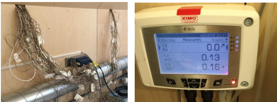
Figur 3. Figuren viser et anemometer i luftespalten, etter montering av taktro. Foto: Lars Gullbrekken.
