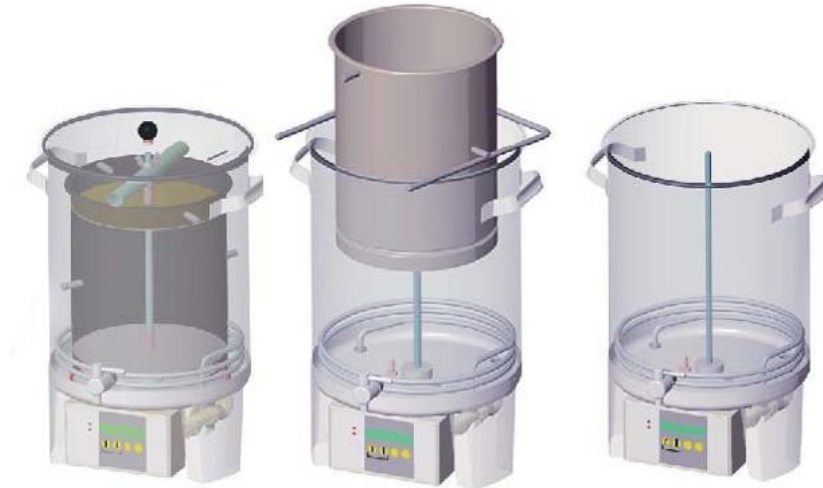
Figur 2.3: Braumeister ølbryggingsoppsett fra Speidel. Til venstre vises bryggekjelen med maltrøret plassert på innsiden. Etter mesking tas maltrøret ut, slik bildet i midten viser, og vørteren siles gjennom et filter og ned i bryggekjelen. Vørteren varmes så opp videre i bryggekjelen slik det er vist i bildet til høyre. Oppsettet ble brukt under bryggeprosjekter ved NTNU (32).
