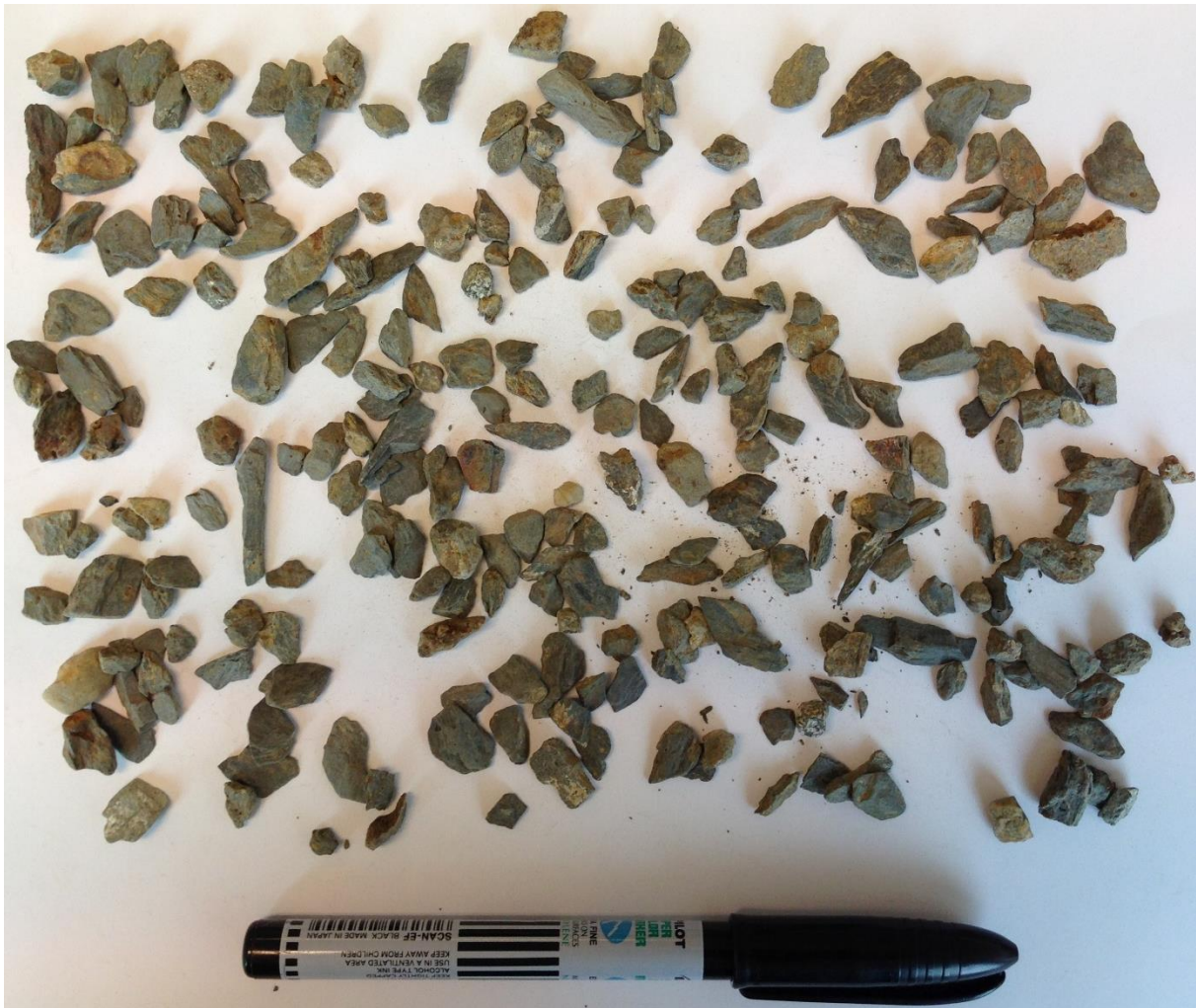
Figur 5.26: Materialet fra groveste fraksjon (4-8 mm) for prøve 17. Prøven karakteriseres som kantet (Foto: Marte Bakka Stemland, 20.04.2016).
