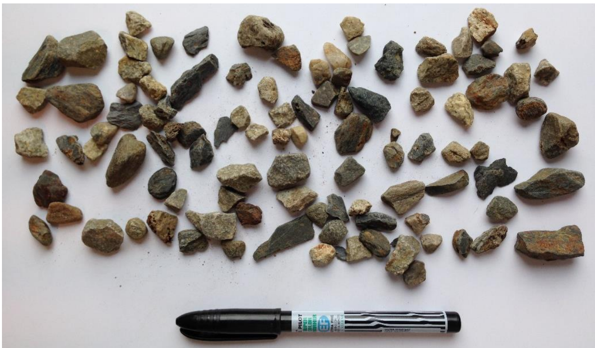
Figur 5.25: Materialet fra groveste fraksjon (8-16 mm) for prøve 16. Prøven karakteriseres som kantet - kantavrundet (Foto: Marte Bakka Stemland, 20.04.2016).
