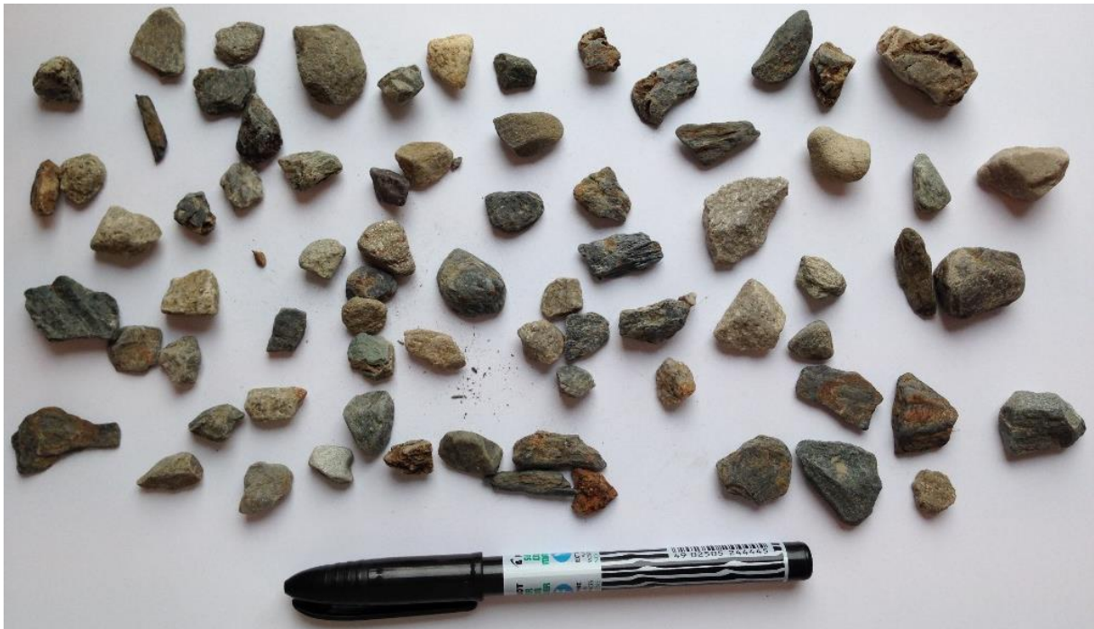
Figur 5.24: Materialet fra groveste fraksjon (8-16 mm) for prøve 15. Prøven karakteriseres som kantet - kantavrundet (Foto: Marte Bakka Stemland, 20.04.2016).
