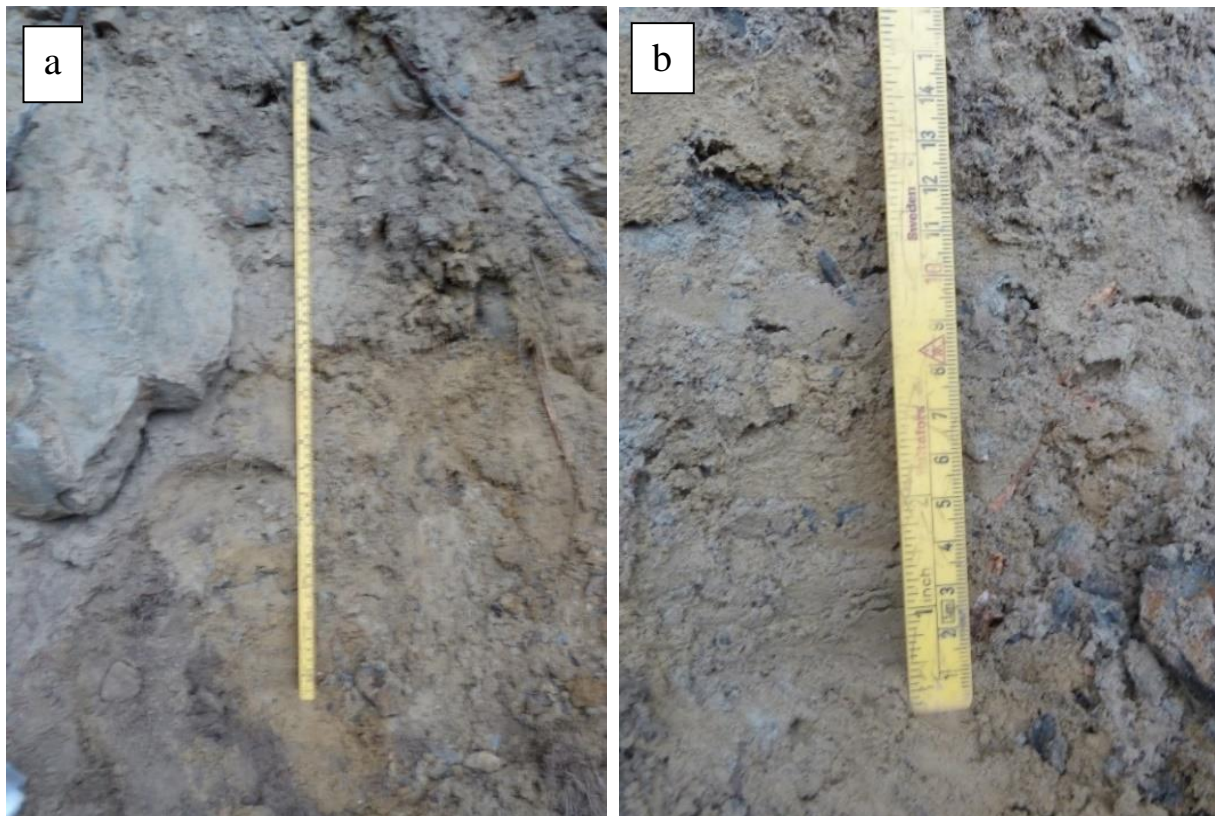
Figur 5.11: Løsmasseprofil i forvittringsmateriale, gravd ut i en vegskjæring: a) Oversiktsbilde av profilet. Tommestokken er 1 m lang. b) Nærbilde av de 15 nederste cm av samme løsmasseprofil (Begge foto: Marte Bakka Stemland, 31.10.2015).
