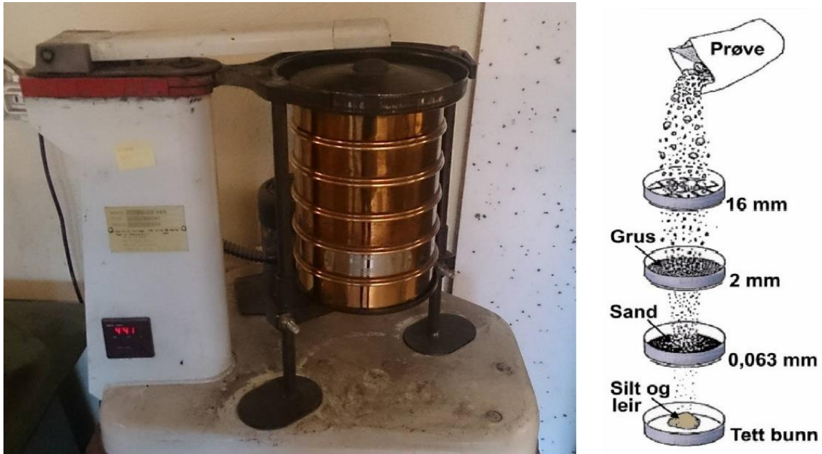
Figur 3.4: Utstyr til bruk i kornfordelingsanalyse. Til venstre: siktmaskinen som ble benyttet til tørrsiktning under kornfordelingsanalysene (Foto: Marit Bakken Gjørva, 29.04.2016). Til høyre: prinsippskisse for sikting av materiale (Jørgensen et al., 2013).
