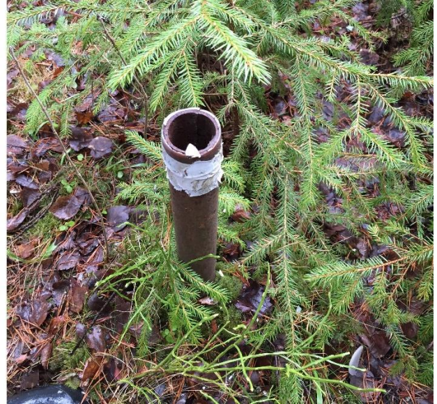
Figur 3.14. Feltbilder av løsmassebrønner på Elverum. Brønn nummer 65880 (t.v.) ved Søbakken skole og brønn nummer 8304 (t.h.) ved Stavåsbekken (Foto: Marit Eline Sandbakken).
