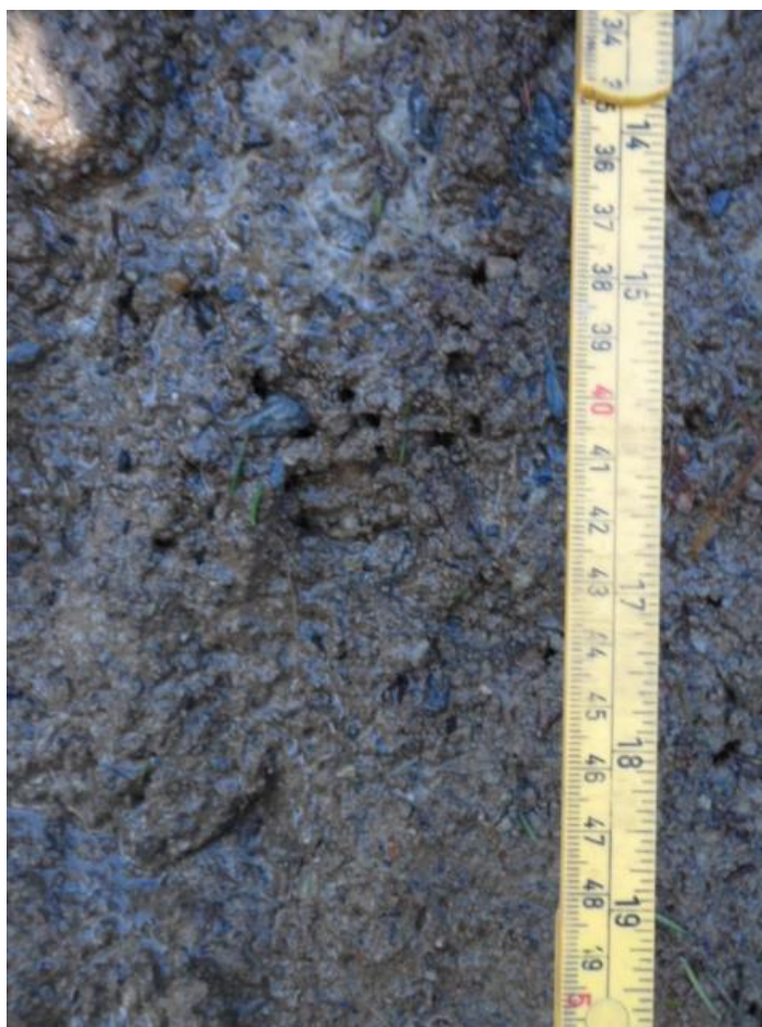
Figur 6.3. Nærbilete av vassmetta materiale i skjering som er kartlagt som finkorna hav- og fjordavsetningar på Horg. Det er tydeleg at materialet består av grovare fraksjonar som kan stamme frå underliggande avsetningar eller forvittringsmateriale (foto: Marit Bakken Gjørva (18.04.2016)).
