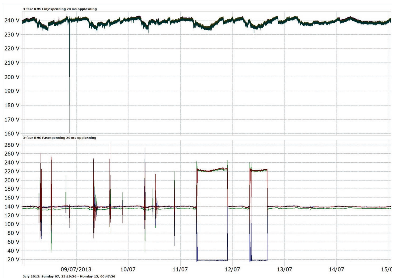
Figur 4.1 Trefase linjespenninger er vist i øverste halvdel av figuren og er tatt med for å vise at det er liten variasjon i linjespenningen og at kun en enkelt hurtig/betydelig endring i fasespenningen også var i linjespenningen. I nederste halvdel av figuren ser man at det i denne uken oppsto 2 litt langvarige jordfeil på mellom 8 og 15 timer samt mange svært kortvarige tilfeller med høyohmige jordfeil.
