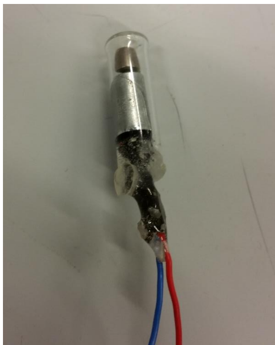
Figur 11 Vibrasjonsenheten som ble brukt for å skaffe hydrodynamisk bevegelse i systemet.
