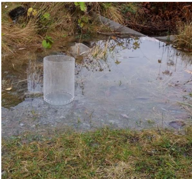
Figur 17 Sylindren under feltarbeid i regnbedet.
