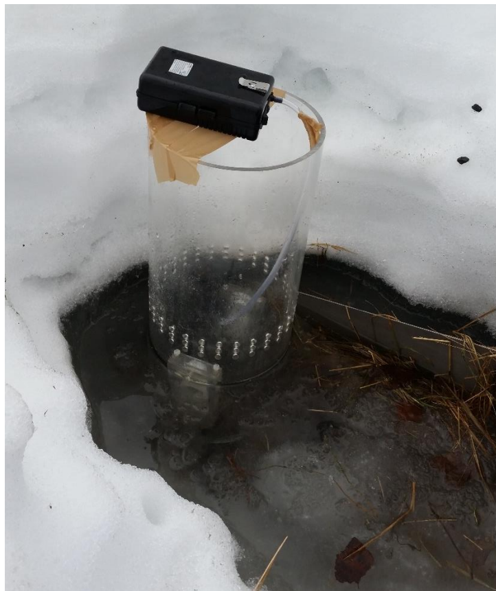
Figur 18 Sylinderen utplassert ved innløpet til regnbedet under vårmeltingen.
