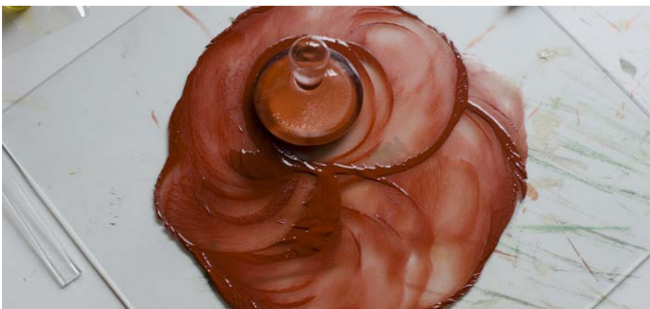
Riving av pigmenter i olje til egen fargepasta som utgangspunkt for linoljemaling.
