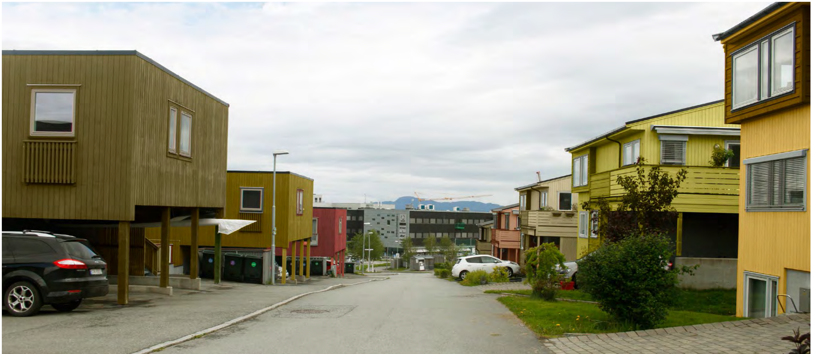
Utsikt ut fra Anton Jenssens vei (redigert foto ved hjelp av Photoshop + NCS Swatches, farger omgjort til observerte farger). De gule og grønne tonene må få spesiell oppfølging opp mot nabohus, siden en gul som er ment å være ren gul (Y), kan dras mot grønnlige toner sett fra avstand (såsom G80Y), og lett påvirkes av nabofarger.
