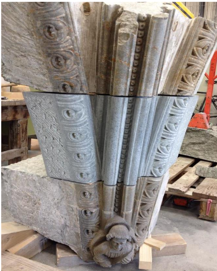
Figur 10. I midten, til venstre, nytt, profilert objekt med tre ulike buer. Til høyre: Malene brukt i tilnærming til formen. (Foto: NDRs verksted).
