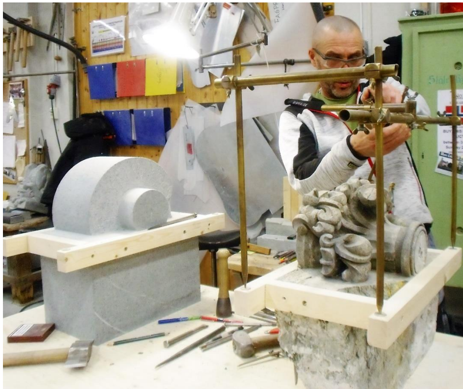
Figur 11. Punkteringsapparat i bruk, her plasser på modellen for å stille inn nåla på ønsket punkt. (Foto: Eva Stavsvøien).
