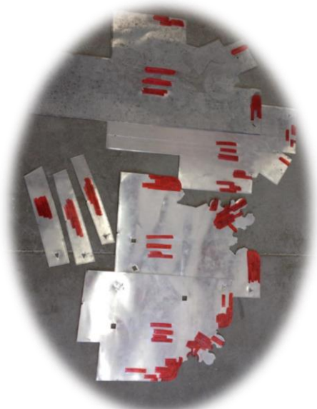
Figur 10. I midten, til venstre, nytt, profilert objekt med tre ulike buer. Til høyre: Malene brukt i tilnærming til formen. (Foto: NDRs verksted).
