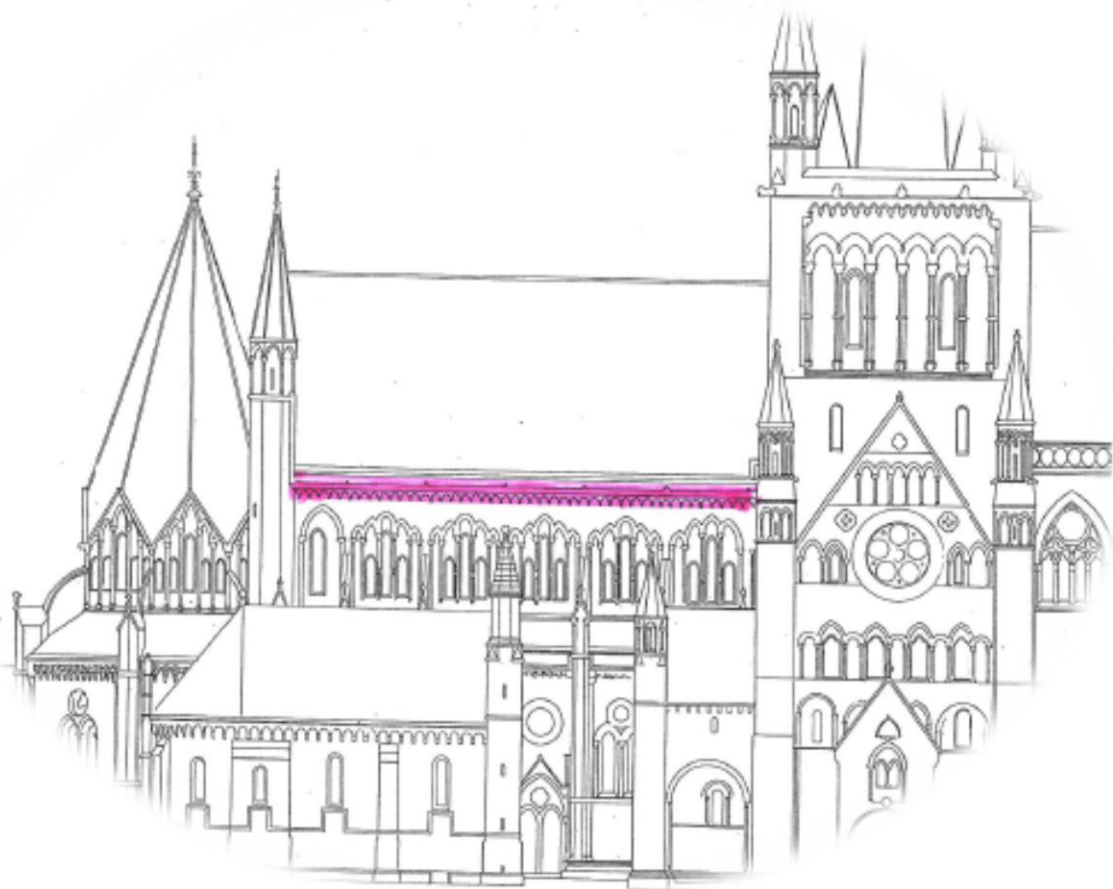
Figur 4. Tegning, Korets Nordre fasade, området hvor rennebærere og konsoller befinner seg er markert med rosa farge. (NDR, unummerert tegning, signert Arne Gunnarsjaa).
