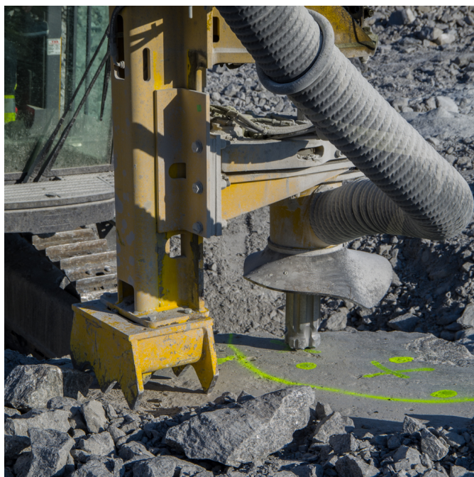
Figur 5.6: Prøvetaking ved hjelp av borerigg. Det ble boret flere steder rundt midten (markert med gult (grønt) kryss) for så å ta prøver fra det som var fast fjell.
