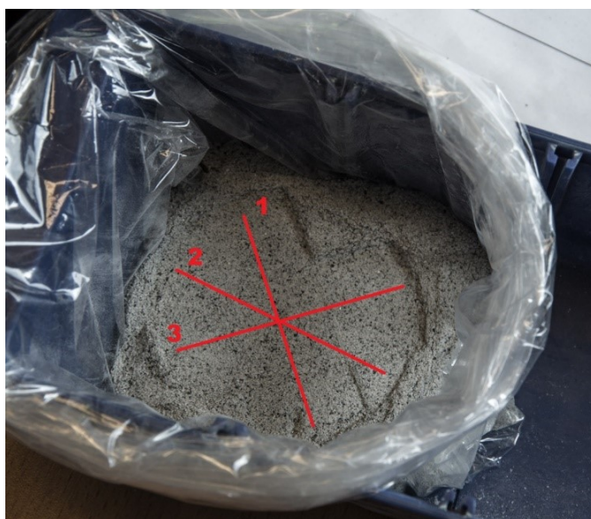
Figur 5.7: Prosedyre for susceptibilitetsmåling på prøveposer. Det ble gjort 3 uavhengige prøver langs linjene markert med rødt.
