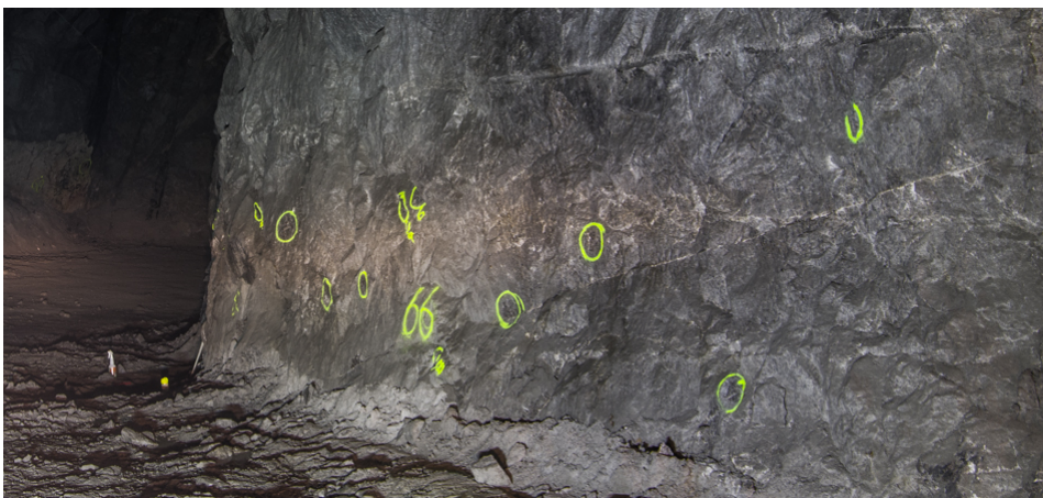
Figur 5.3: Prøvetakning på profiler. Bildet er tatt fra midten av Profil 2. Prøvepunktene er markert med gule sirkler, hvor alle målingene på punktet er foretatt innenfor. Merk at borehull ST-K2014-066 også er markert.
